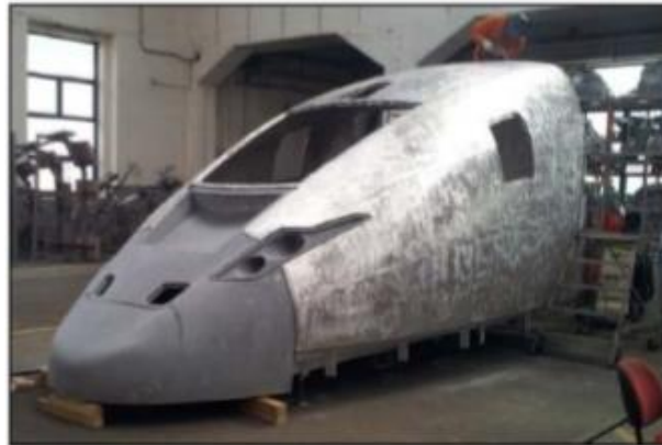
Slika 38. Primjena AFS-a u industriji vlakova [13]
