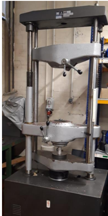
Slika 66. Univerzalna kidalica WPM EU 40 mod.
