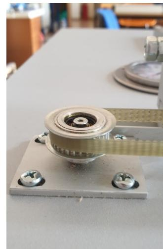
Slika 34. Enkoder (lijevo) i remenica (desno) povezani remenom
