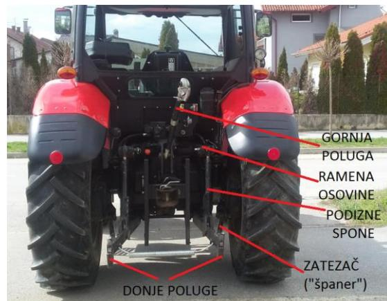
Slika 19: Stražnja poteznica traktora „Zetor Proxima“ u 3 točke
