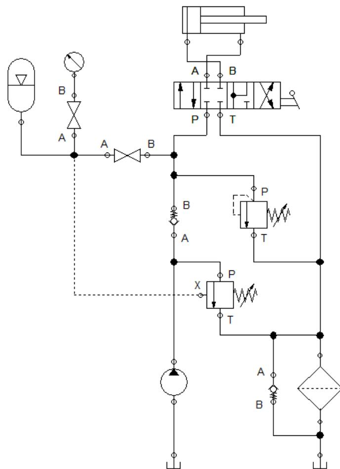
**Slika 89:** Shema hibridnog hidrauličnog sustava cjepeča u programu FluidSIM
