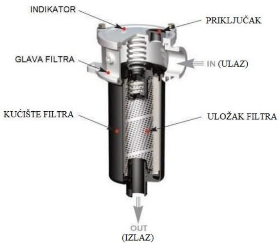
**Slika 41:** Dijelovi povratnog filtra  $\frac{3}{4}''$  – 60u – 110 l/min [27]
