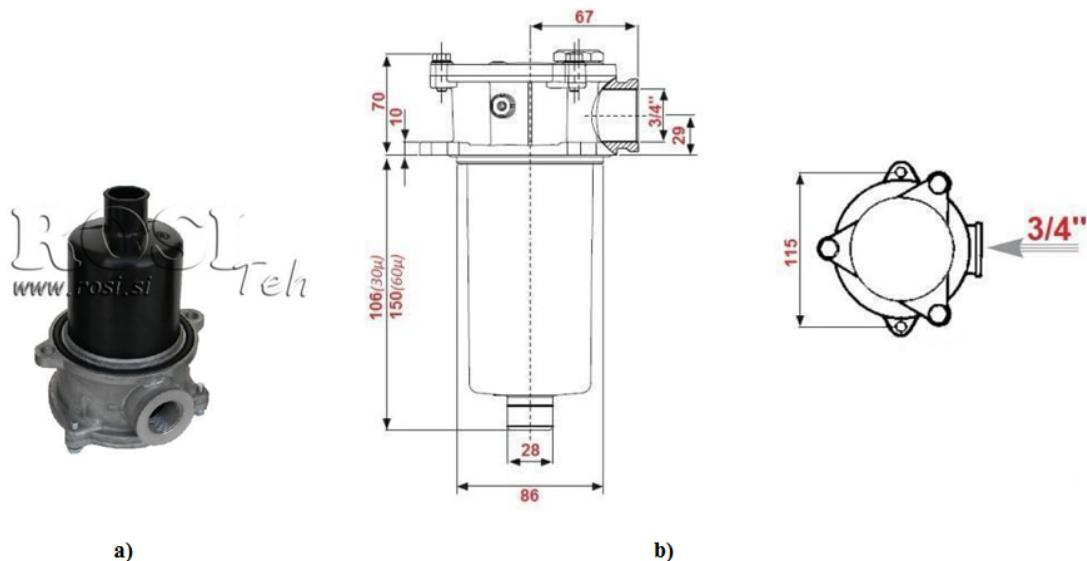
Slika 40: Povratni filter  $\frac{3}{4}''$  60u – 110 l/min : a) fotografija [27], b) tehnički crtež [27]
