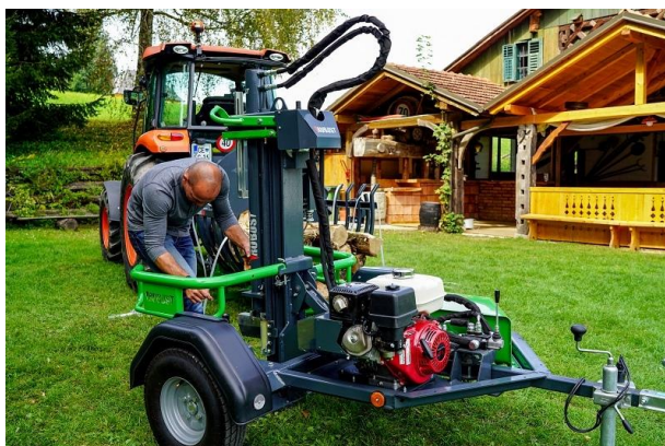
Slika 7: Cjepač pogonjen benzinskim motorom „Robust BA“ [5]
