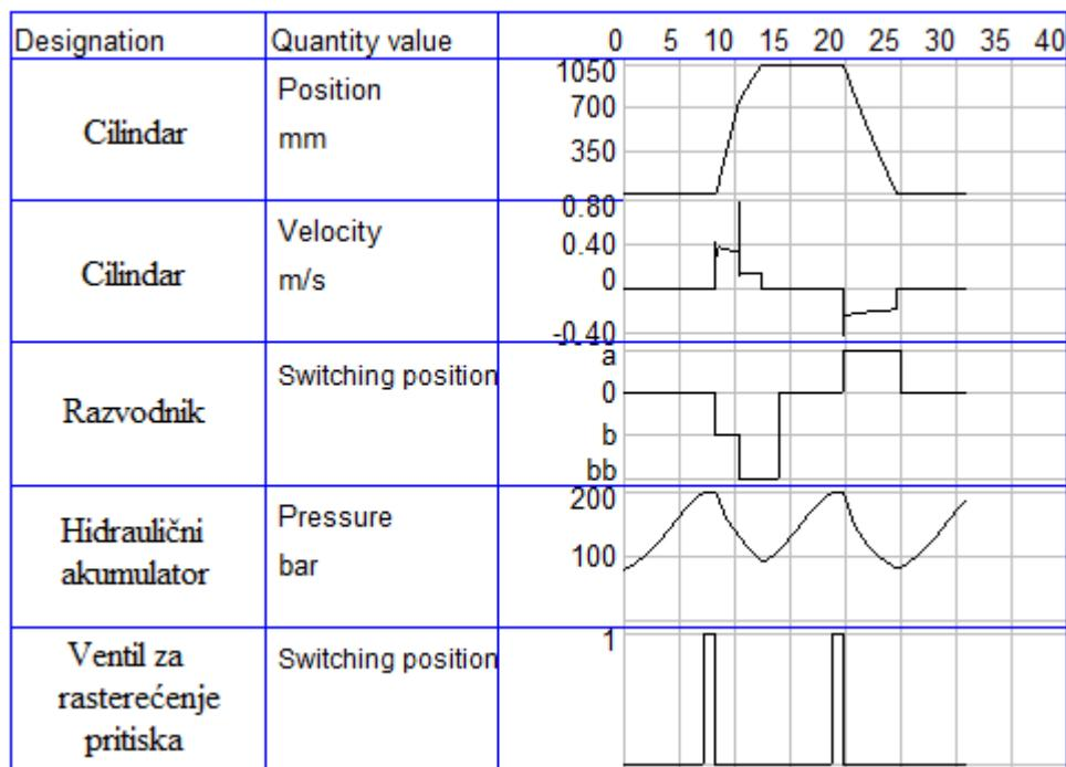
Slika 107: Dijagram ponašanja cilindra, razvodnika, akumulatora te ventila za rasterećenje pritiska
