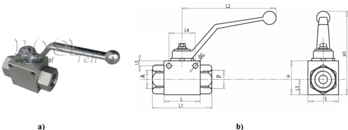
Slika 48: Hidraulični zaporni ventil RS2 [27]: a) fotografija, b) tehnički crtež
