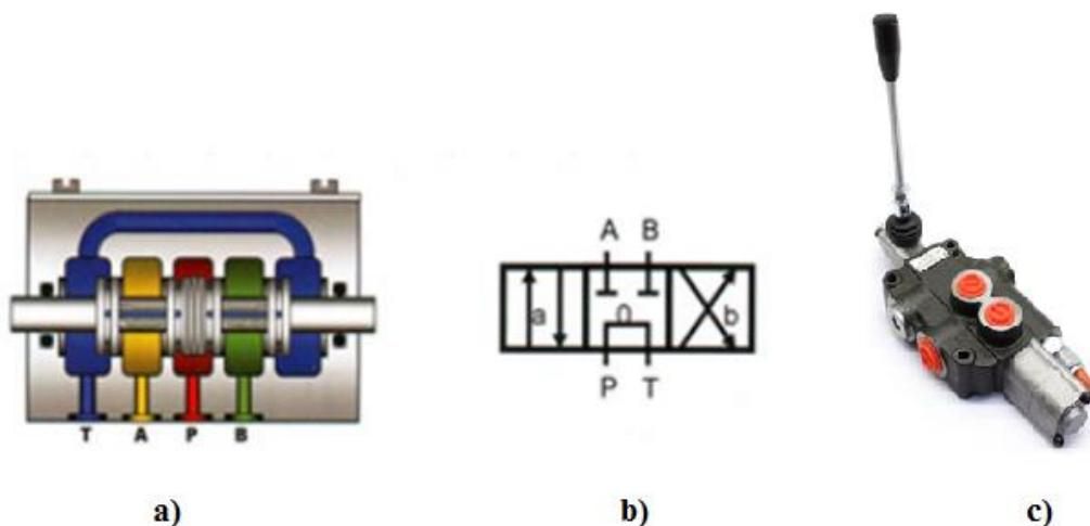
**Slika 29:** Hidraulični razvodnik s tandem centrom: a) presjek [20], b) simbol [20], c) fotografija poluautomatskog razvodnika [23]
