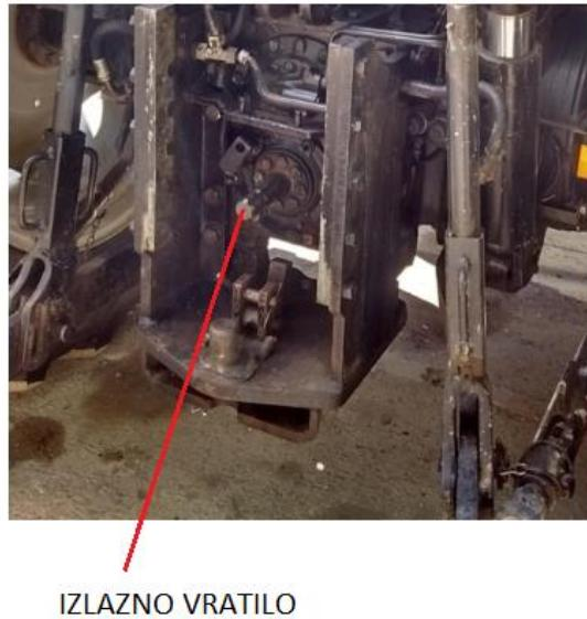
**Slika 22: Izlazno vratilo traktora**
