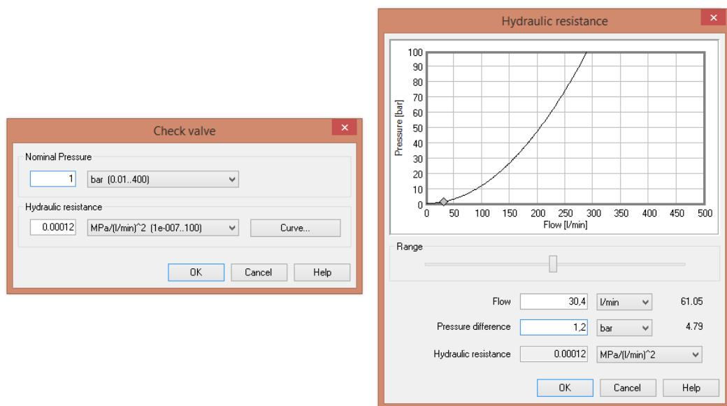
Slika 93: Unos karakteristika nepovratnog ventila VU ¾“ između pumpe i razvodnika
