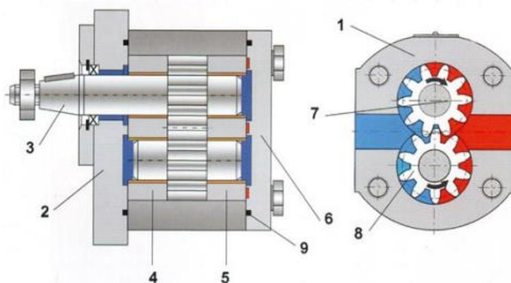
**Slika 28: Dijelovi zupčaste pumpe s vanjskim ozubljenjem [20]**
