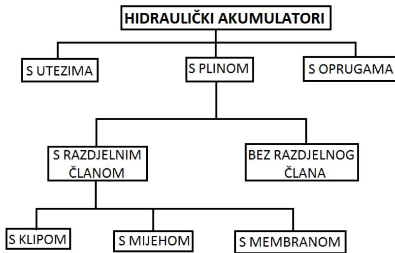
Slika 50: Podjela hidrauličkih akumulatora [20]
