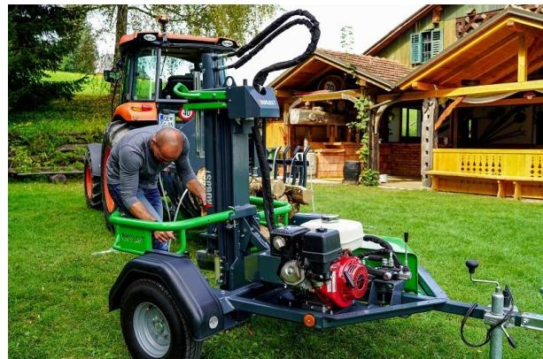
Slika 7: Cjepač pogonjen benzinskim motorom „Robust BA“ [5]
