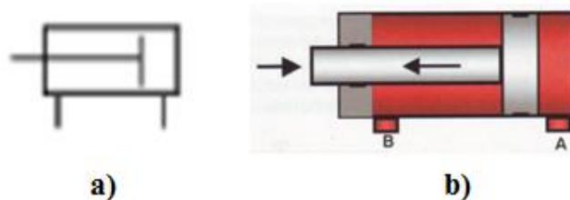
Slika 25: Dvoradni cilindar: a) simbol [21], b) presjek [20]
