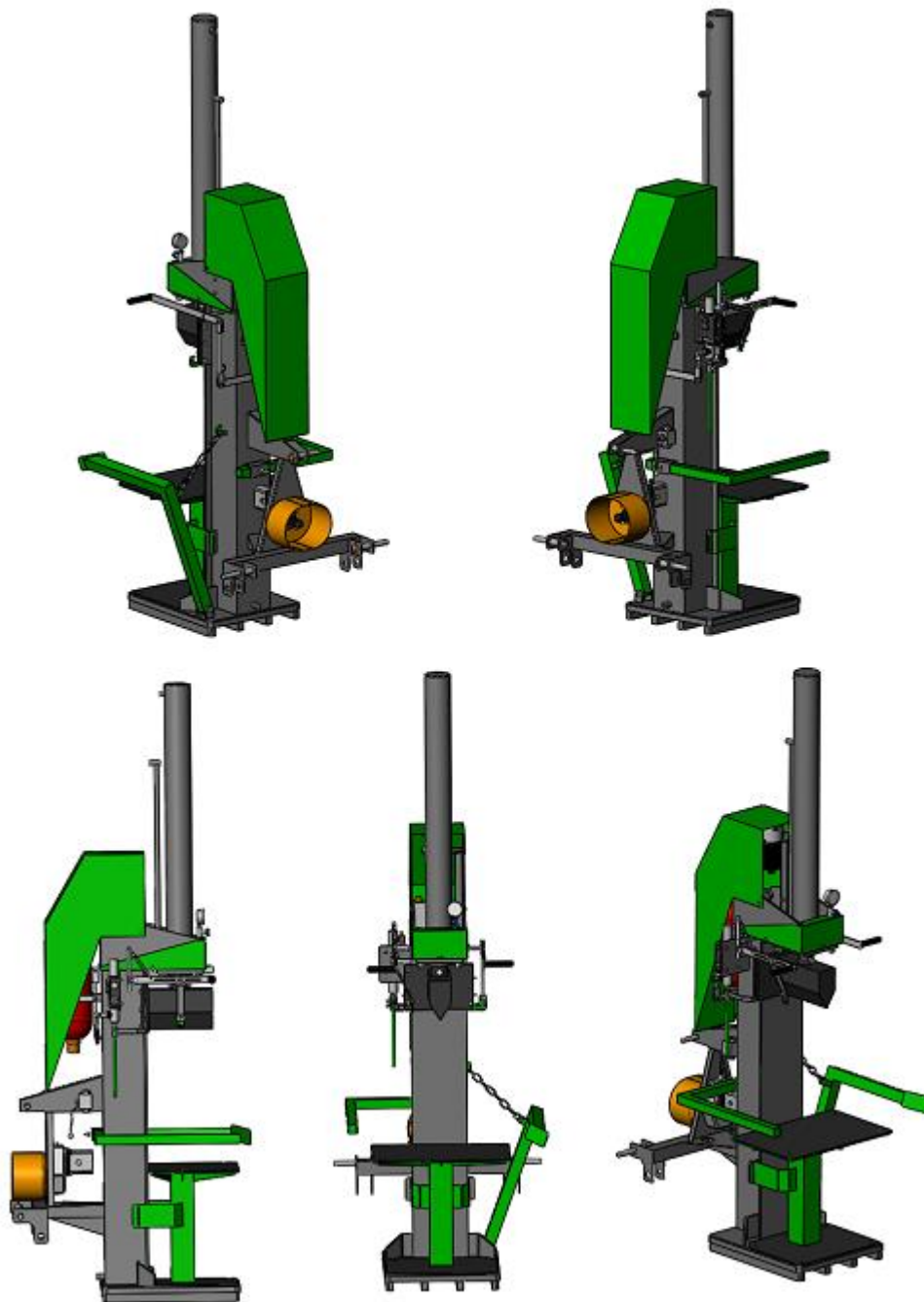
Slika 75: Različiti pogledi na računalni model cjepača
