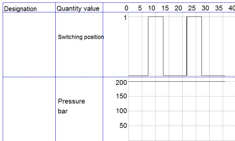
**Slika 105: Prikaz ponašanja ventila za rasterećenje pritiska akumulatora**
