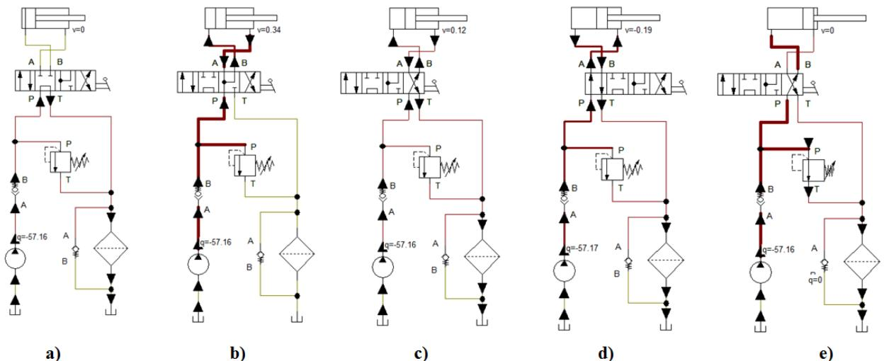
**Slika 82:** Simulacija klasičnog sustava kod položaja razvodnika za: a) tandem centar, b) brzi hod cilindra, c) normalni hod cilindra, d) povratak cilindra, e) normalni hod kod krajnjeg položaja cilindra
