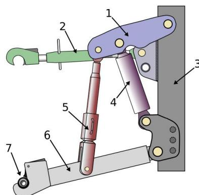
Slika 20: Izvedba dizanja u tri točke [17]
