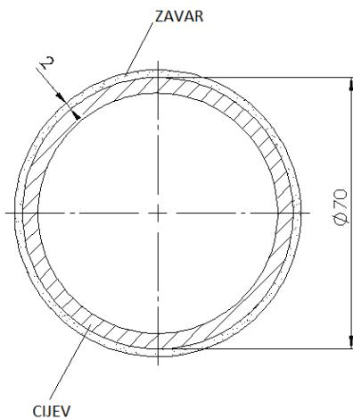
Slika 73: Prikaz zavara oko cijevi
