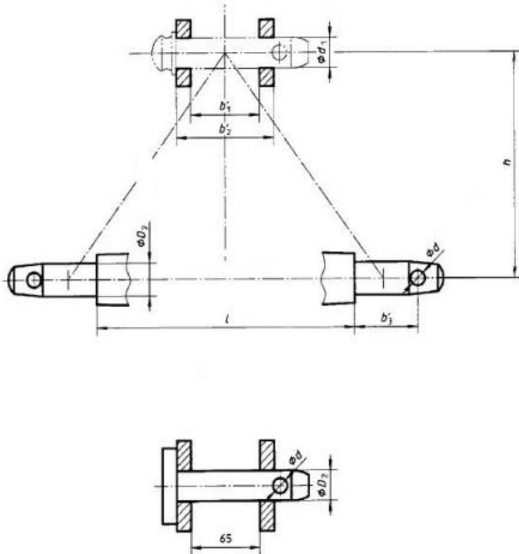
Slika 21: Dimenzije standardiziranog priključka prema normi ISO 730-1 [18]
