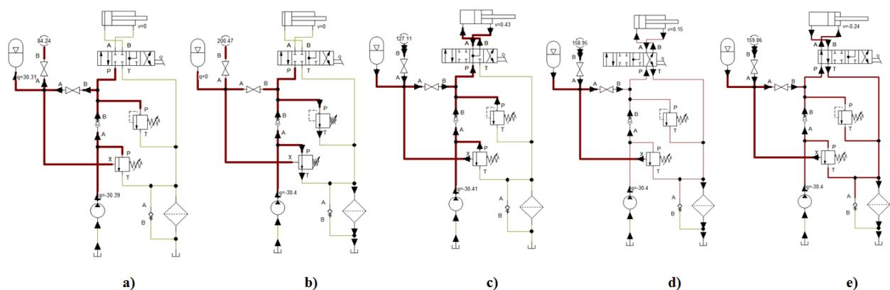
**Slika 97:** Prikaz simulacije hibridnog sustava kod položaja razvodnika za: a) zatvoreni centar, b) zatvorenog centra i potpuno napunjenoj akumulatoru, c) brzi hod cilindra, d) normalni hod cilindra, e) povratak cilindra
