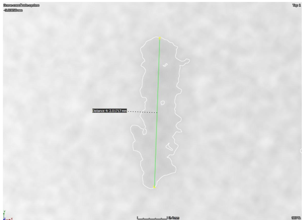
Slika 33. CT snimka referentnog reflektora pod kutom  $70^\circ$
