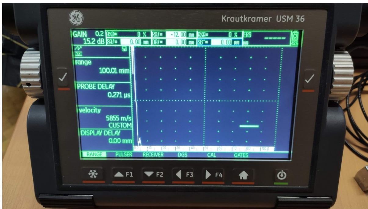
Slika 34. Ultrazvučni uređaj korišten u eksperimentalnom dijelu diplomskog rada (Krautkramer USM 36)
