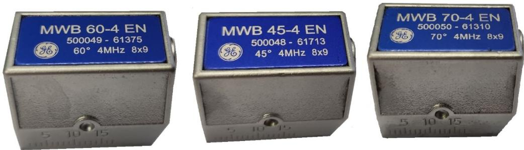
Slika 35. Ultrazvučne sonde
