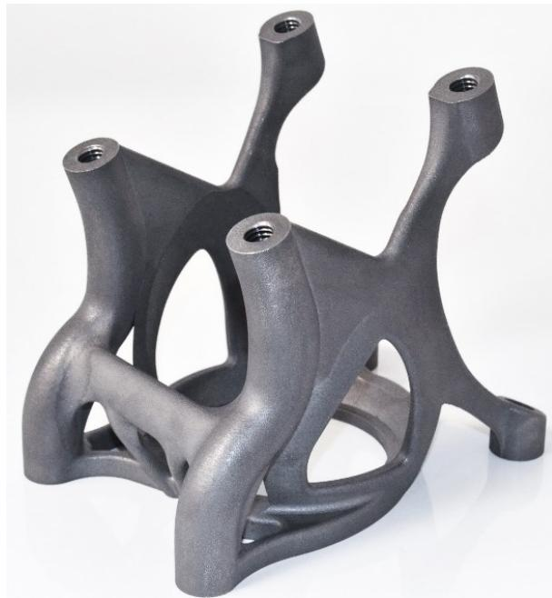
**Slika 25. Metalna tvorevina izrađena aditivnim postupkom DMLS [21]**
