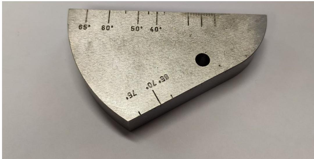
Slika 36. Referentni etalon V2
