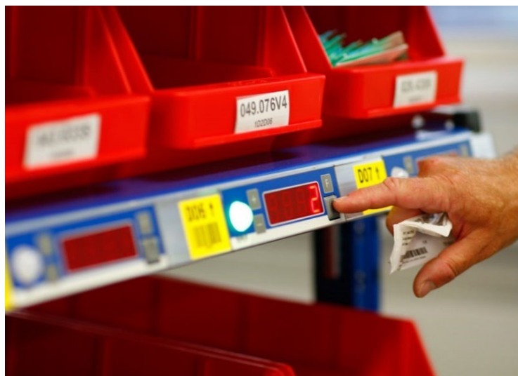
Slika 28. „Pick to light“ sustav
