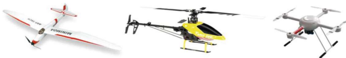
Slika 1.1 Podjela bespilotnih letjelica – letjelice s fiksnim krilima (lijevo), helikopteri (sredina) i multirotori (desno)
