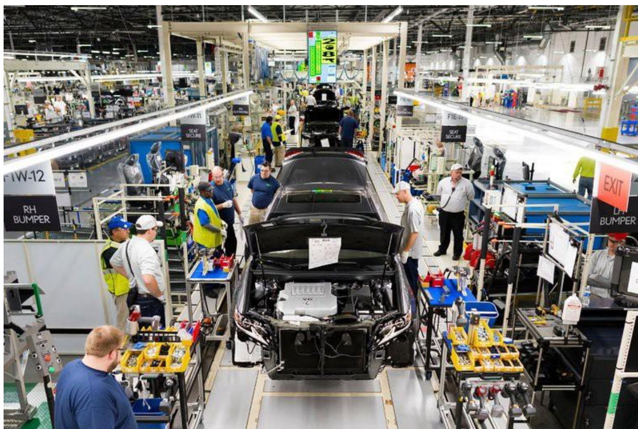
Slika 41. Proizvodnja automobila uz taktno vrijeme i standardizaciju rada [206]
