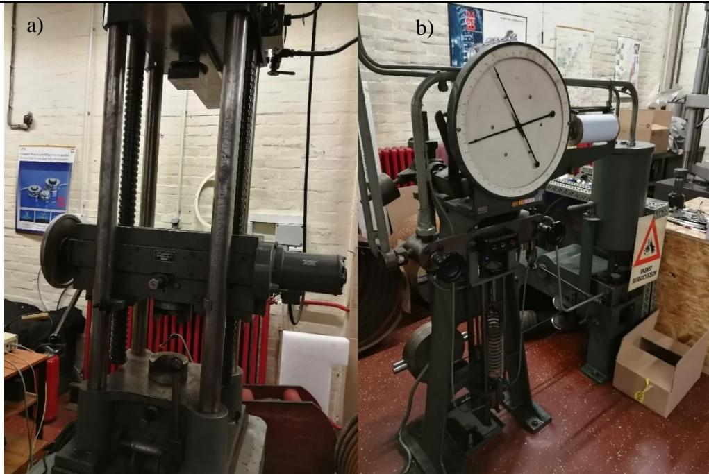
Slika 3.3 Nosiva konstrukcija kidalice i sustav za očitavanje
