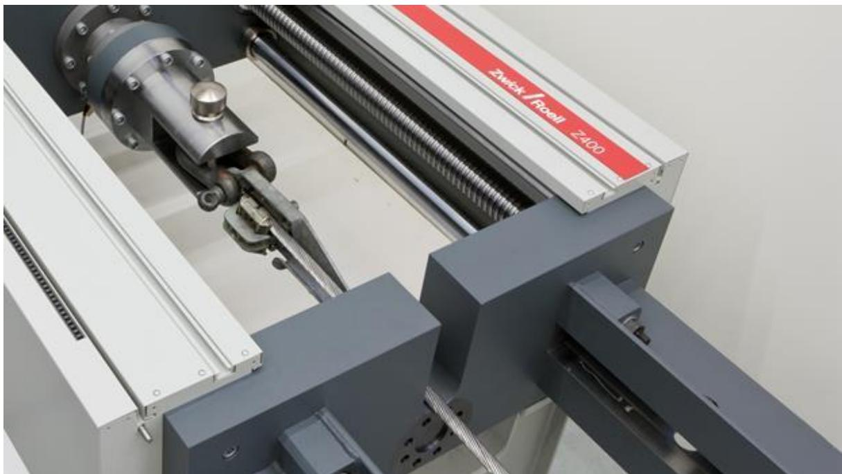
**Slika 4.3 Moderna Zwick-ova kidalica za ispitivanje užadi [11]**
