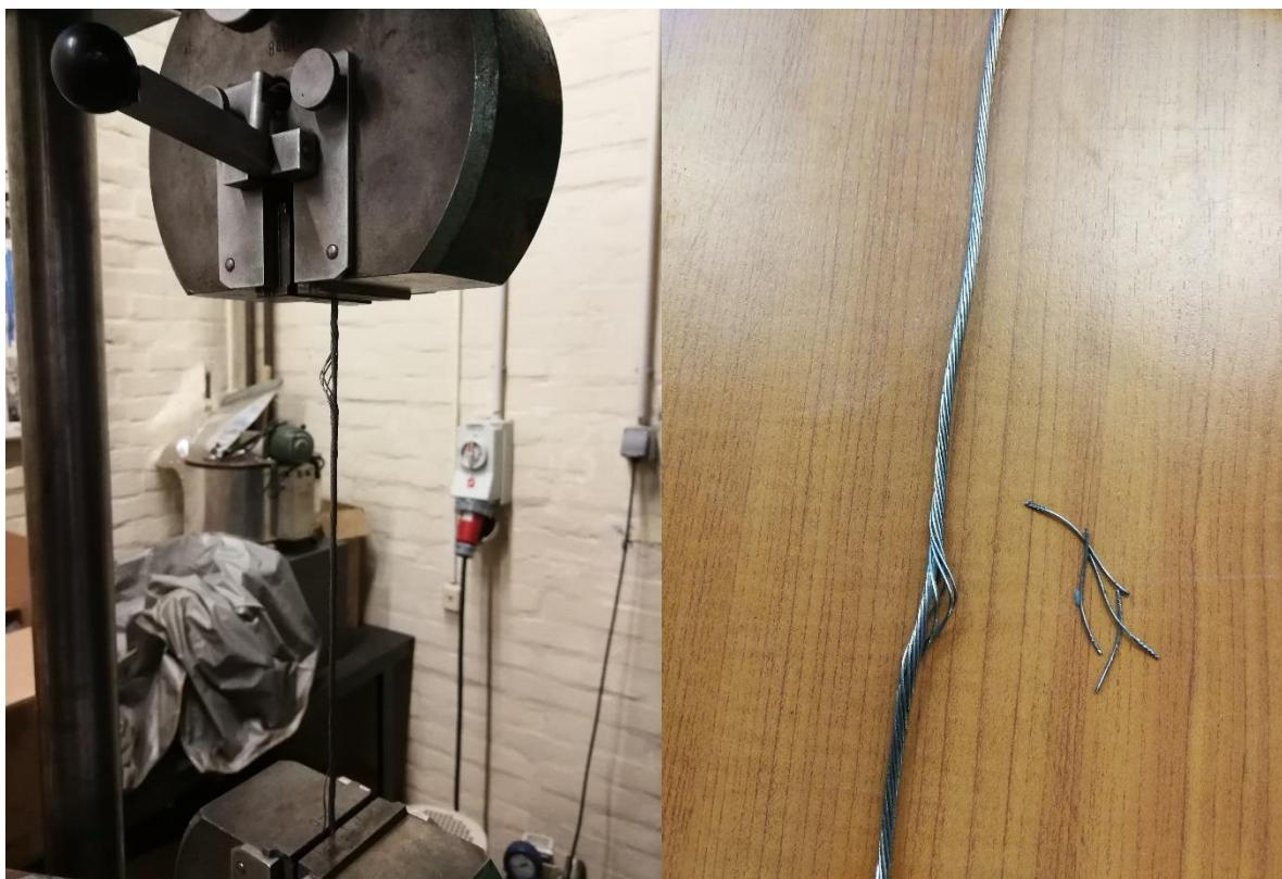
Slika 3.8 Slomljeni kabel
