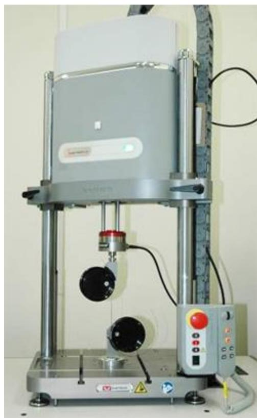
Slika 4.12 Naprava namijenjena za SVI čeličnih žica [12]
