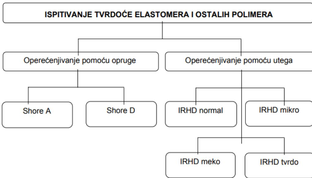
Slika 2.2. Metode za ispitivanje tvrdoće polimera [2]
