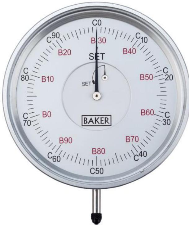
Slika 3.4. Mjerilo Rockwell tvrdomjera [8]
