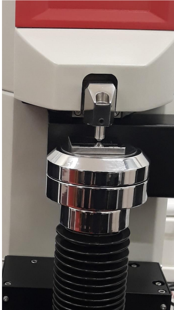
Slika 5.9. Trenutak utiskivanja indentora u pločicu prilikom umjeravanja
