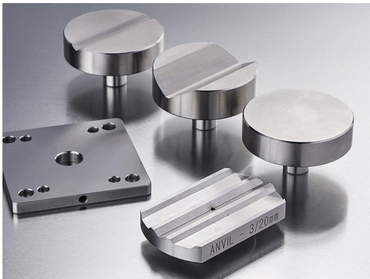
Slika 3.5. Varijante postolja za ispitne uzorke [9]
