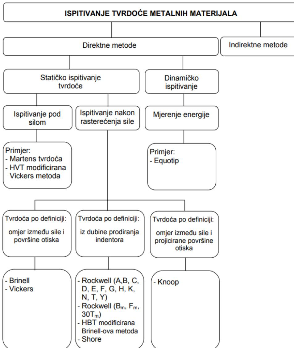
Slika 2.1. Metode za ispitivanje tvrdoće metalnih materijala [2]
