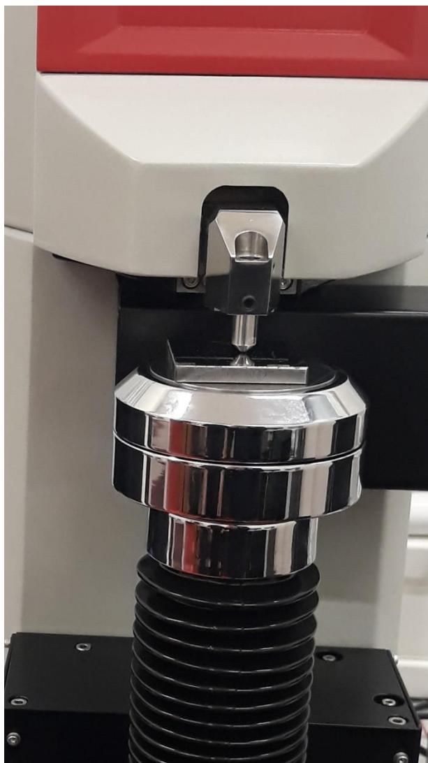
Slika 5.9. Trenutak utiskivanja indentora u pločicu prilikom umjeravanja
