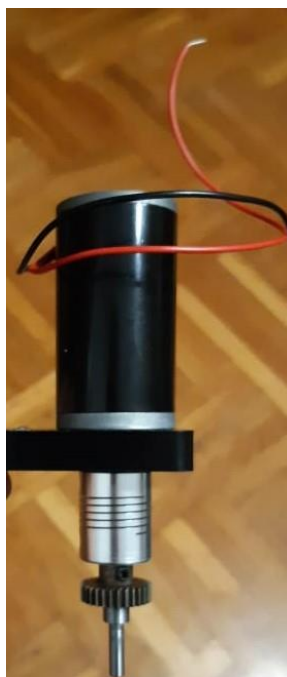
Slika 38 – Motor pričvršćen na donju ploču te spojen elastičnom spojkom na vratilo dva na kojem se nalazi zupčanik
