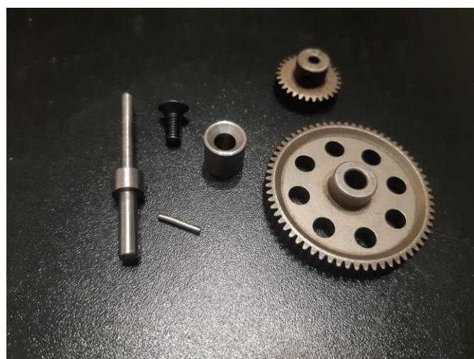
Slika 37 – Zupčasti prijenosnik, čahura, vijak s opuštenom glavom M6x5, vratilo dva
