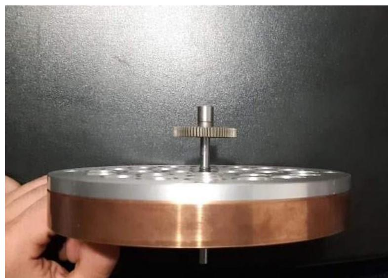
Slika 36 – Sklop bakrenog zamašnjaka, aluminijskog poklopca, vratila jedan i zupčanika
