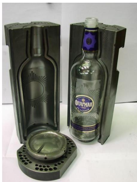
**Slika 19 Kalup, dno kalupa i gotov proizvod [6]**
