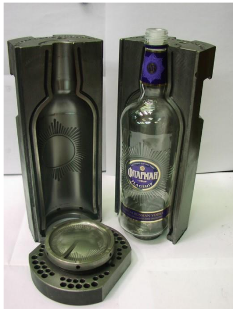
Slika 19 Kalup, dno kalupa i gotov proizvod [6]
