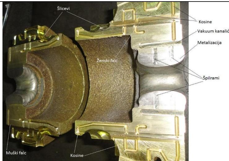
**Slika 38 Grlo nakon uzdužnog glodanja POMET [6]**
