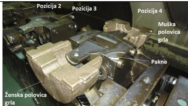
**Slika 37 Grlo na stroju za glodanje [6]**
