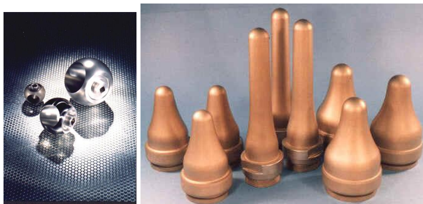
Slika 17. a) Primjer primjene procesa boriranja [14] b). Dijelovi u industriji stakla nakon procesa boriranja [14]
