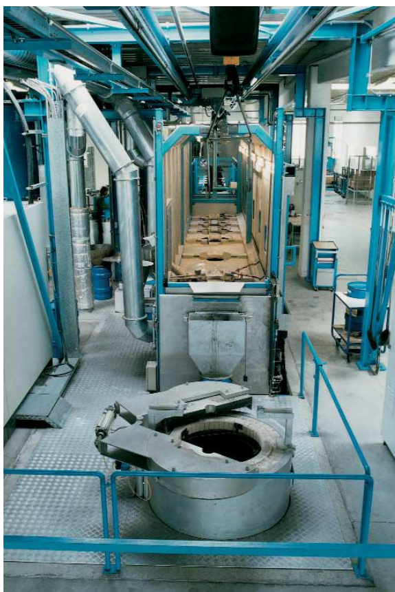
Slika 15. Automatizirano postrojenje za nitrokarburiranje Tenifer-/QPQ [13]
