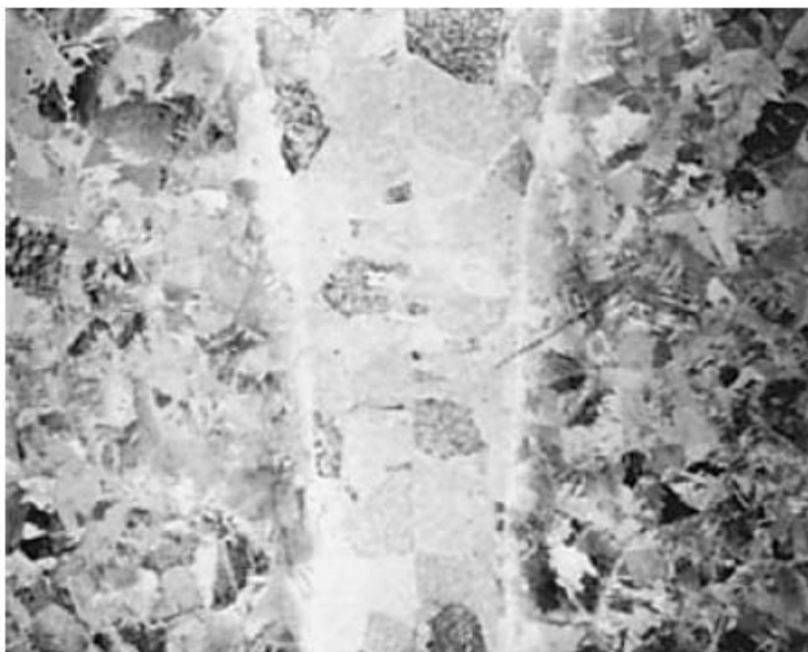
Slika 10. Makrografski prikaz veličine grubih prior-beta zrna u zavaru elektronskog snopa Ti-6Al-4V legure [1].
