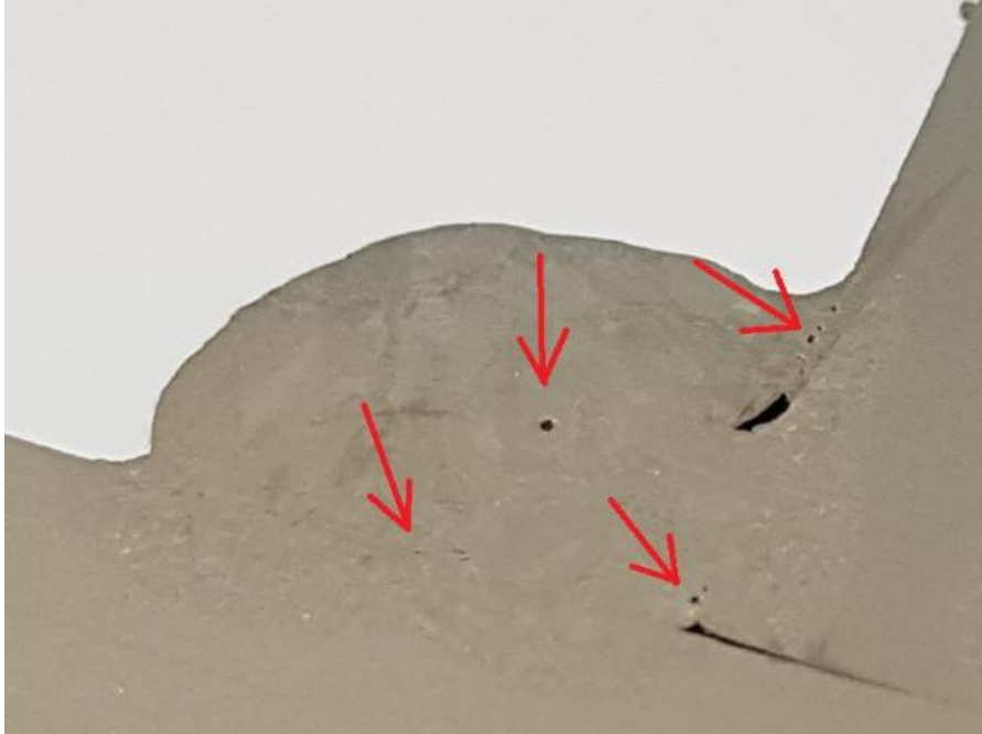
Slika 52. Pore po presjeku zavora uzorka A
