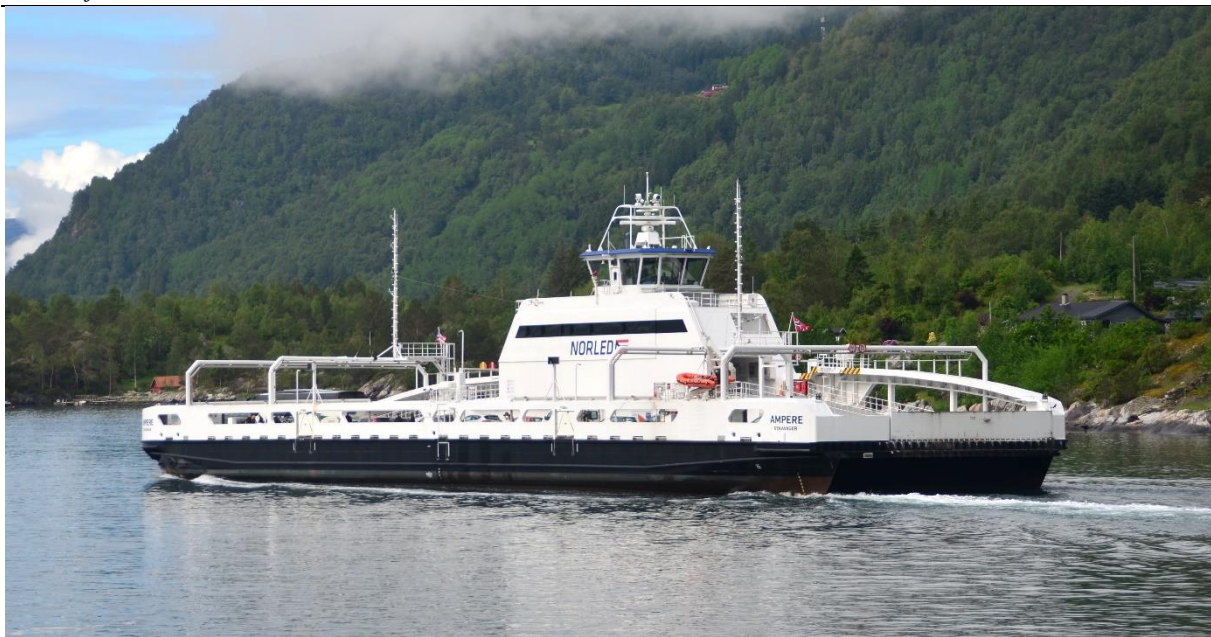
Slika 9. Norveški potpuno električni trajekt MV Ampere [36]
