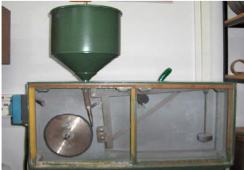
Slika 36. Prikaz uređaja “suhi pijesak/gumeni kotač”
