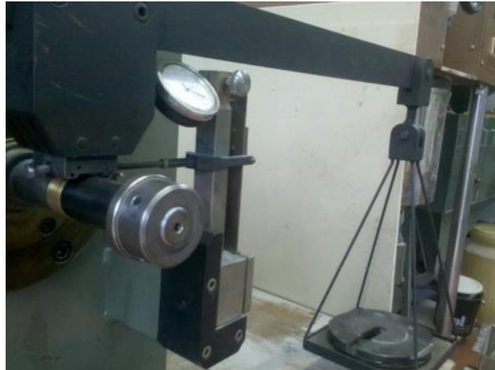
Slika 38. Prikaz uređaja "prizma po prstenu"
