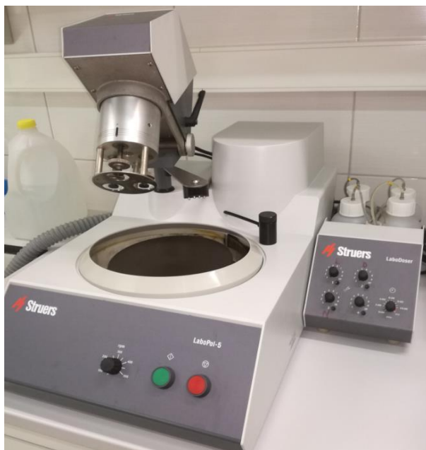
Slika 30. Uređaj za brušenje i poliranje Struers, LaboPol-5
