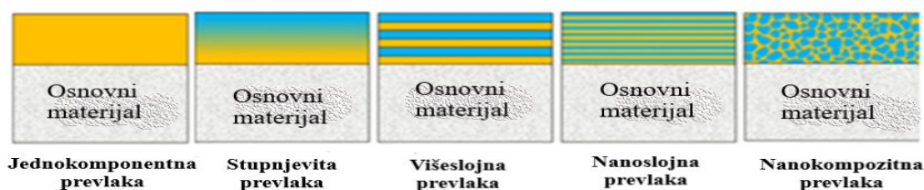
Slika 5. Primjeri triboloških prevlaka prema sastavu i obliku [19]
