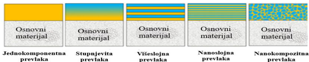
Slika 5. Primjeri triboloških prevlaka prema sastavu i obliku [19]
