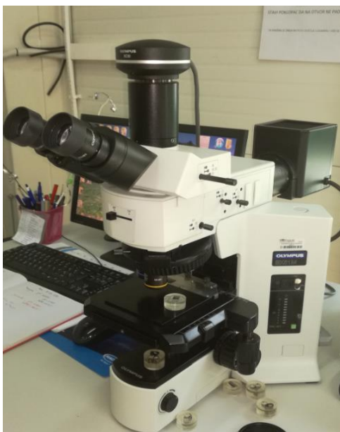
Slika 31. Optički svjetlosni mikroskop Olympus BX51M
