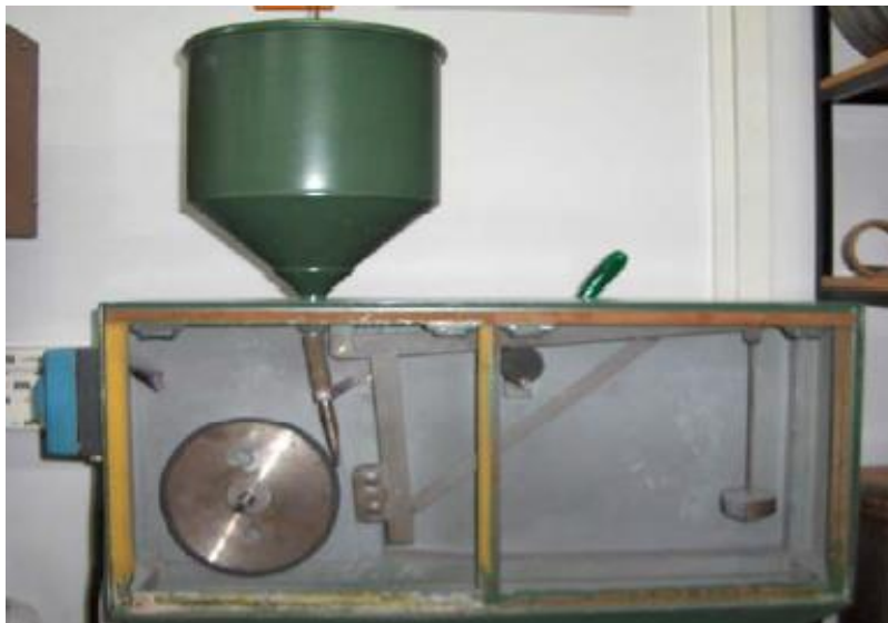
Slika 36. Prikaz uređaja “suhi pijesak/gumeni kotač”
