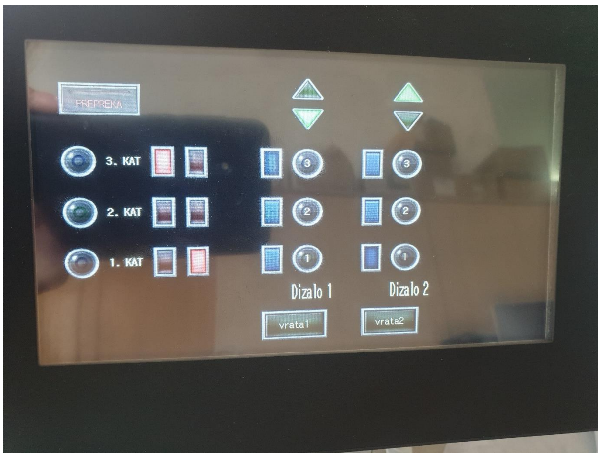
Slika 24. Izgled HMI ekrana za odabir lokacija dizala
