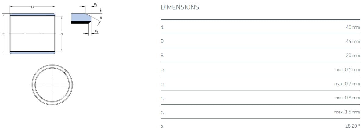
**Slika 44. Karakteristike kliznog ležaja PCM 404420\_E**
