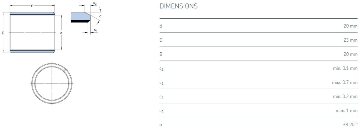
**Slika 46. Karakteristike kliznog ležaja PCM 202320\_E**
