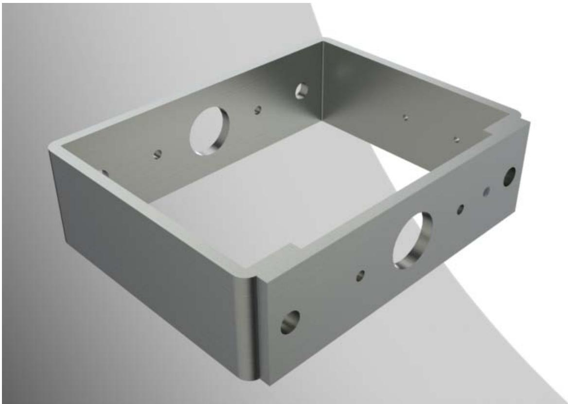
Slika 19: Osnova kućišta mjenjača
