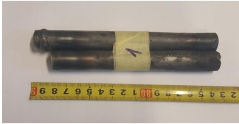
Slika 37: Uzorak A nakon statičnog vlačnog pokusa
