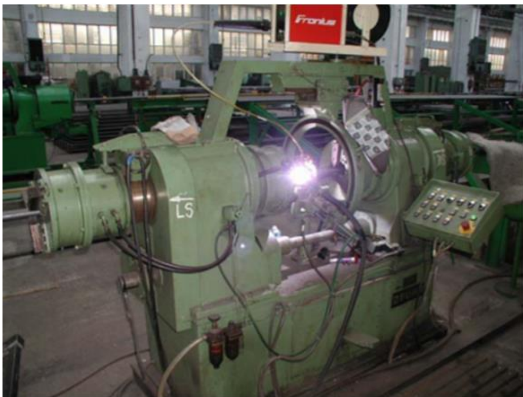
Slika 17: Automatski postupak TIG zavarivanja s okretanjem cijevi [20]
