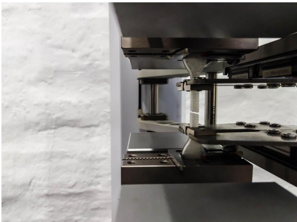
Slika 8: Epruveta nakon pucanja
