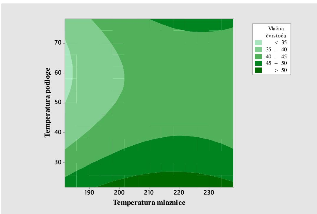
**Slika 15:** 2D dijagram vlačne čvrstoće [MPa] izvnornog PLA u ovisnosti o temperaturi podloge [°C] i temperaturi mlaznice [°C]
