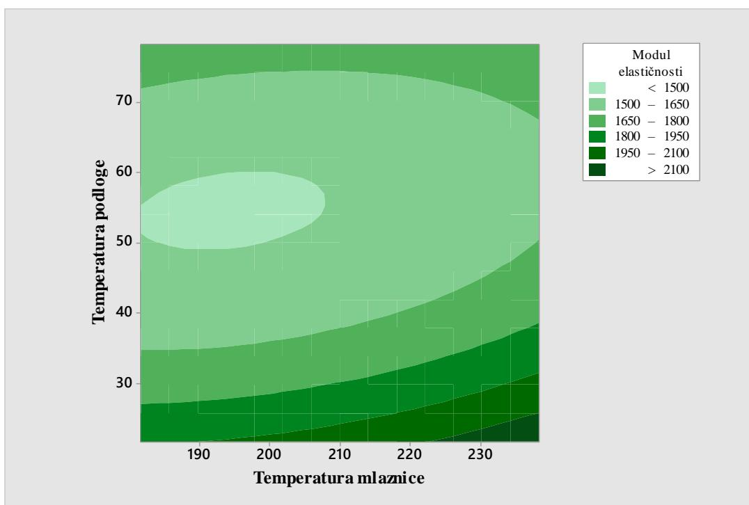
**Slika 17:** 2D dijagram modula elastičnosti [MPa] izvnornog PLA u ovisnosti o temperaturi podloge [°C] i temperaturi mlaznice [°C]
