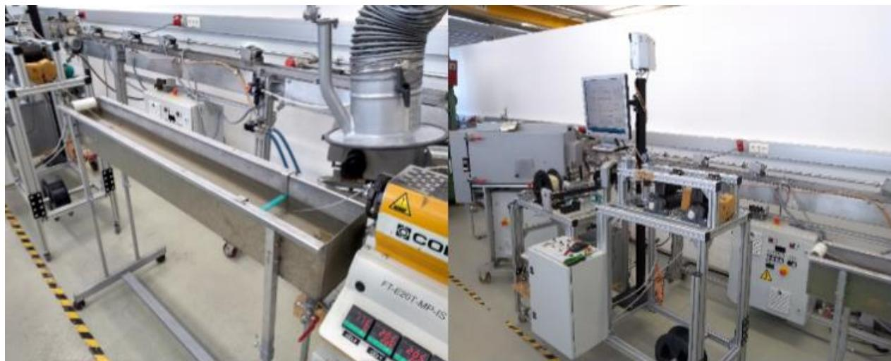
**Slika 11: Jedinica za hlađenje i namotavanje filamenta**
