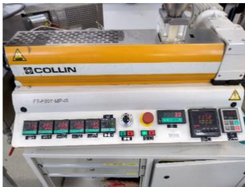
**Slika 10: Jednopužni ekstruder korišten u izradi recikliranog filimenta**
