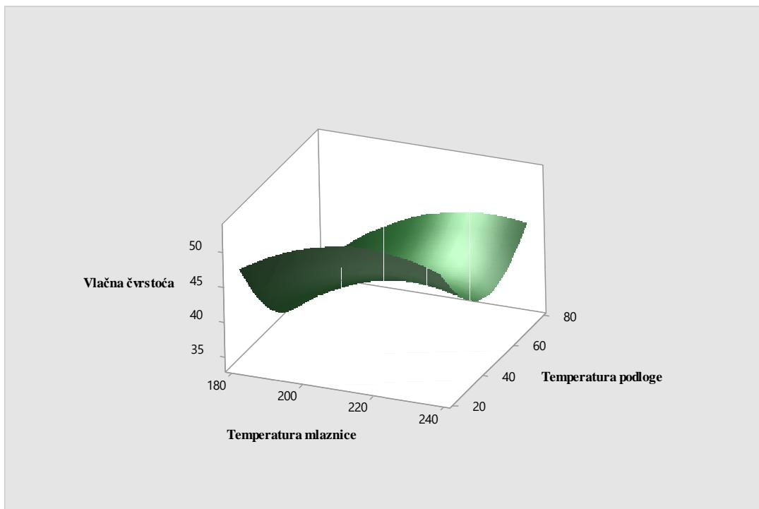
**Slika 14:** 3D dijagram vlačne čvrstoće [MPa] izvnornog PLA u ovisnosti o temperaturi podloge [°C] i temperaturi mlaznice [°C]
