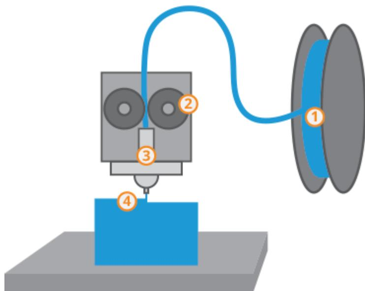
**Slika 2: FDM tehnologija (1-filament, 2-zupčanici, 3-grijać, 4-esktrudirani filament) [3]**
