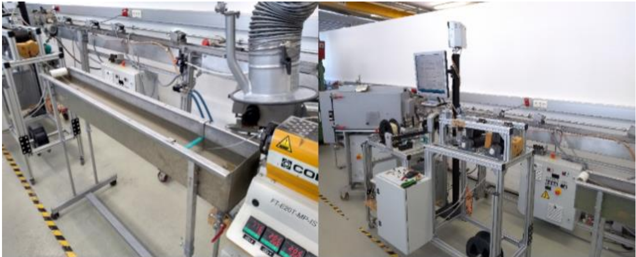
Slika 11: Jedinica za hlađenje i namotavanje filameta
