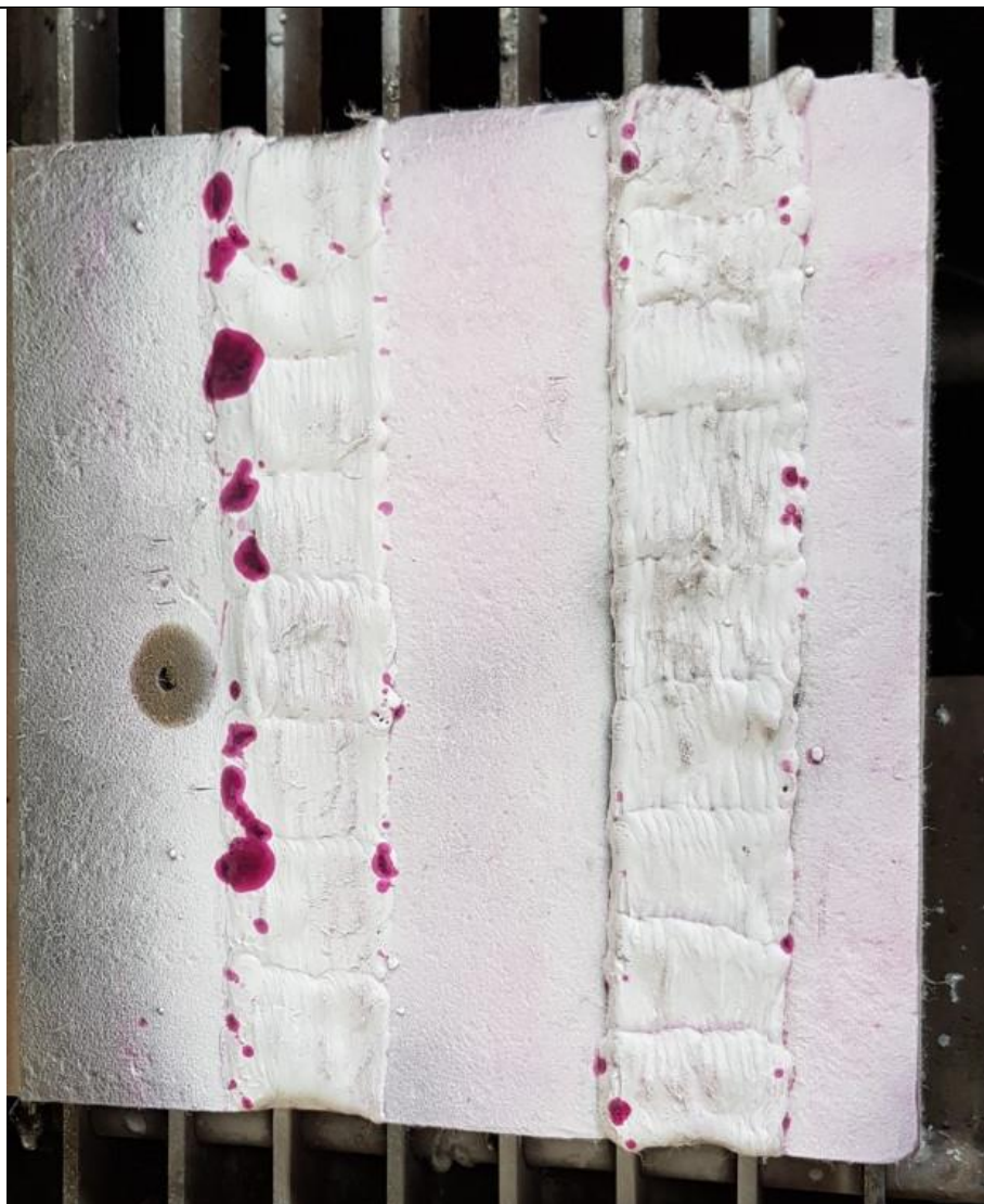
Slika 20 Penetrantsko ispitivanje pukotina
