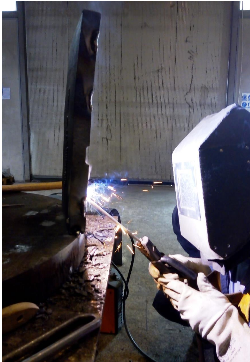
Slika 17 Navarivanje nodularnog lijeva REL postupkom
