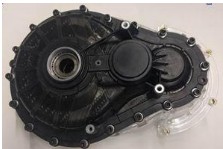
Slika 28 Prototipno kompozitno kućište s aluminijskim umetcima [31]
