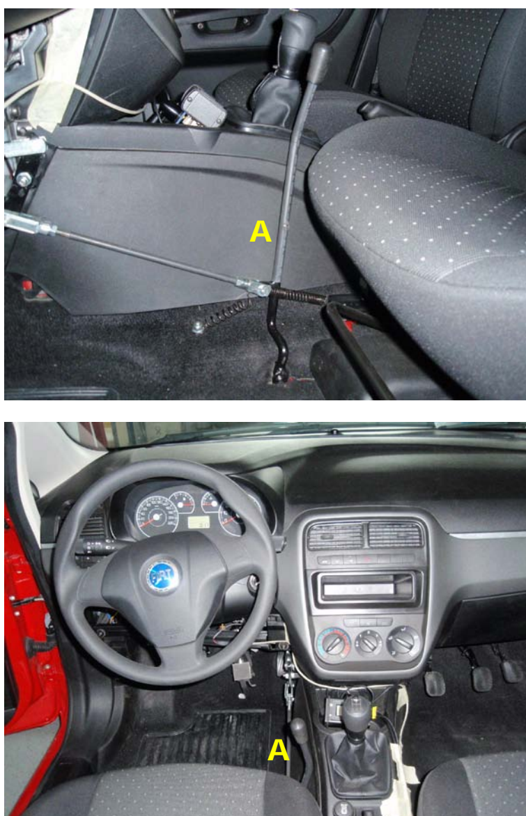
Slika 23. Smještaj poluge/ ručice (A) u kabini vozila
