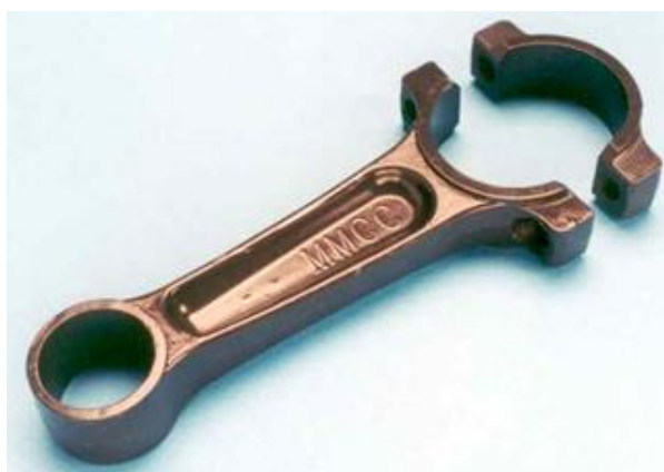
Slika 3.1 Klipnjača napravljena od legure aluminijske ojačane Al_2O_3 česticama [1]
