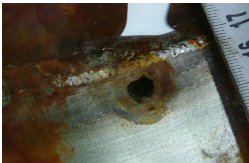
Slika 32. Rupičasto oštećenje zavarenog spoja ispod uklonjenih nakupina biofilma na čeliku EN 1.4307 [33]
