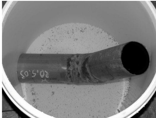
Slika 36. Uzorak odrezane cijevi uronjen u vodu koja se koristila u pogonu [35]
