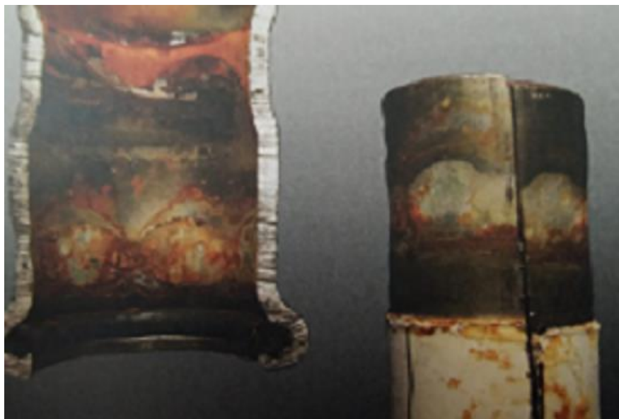
Slika 49. Korozija u procijepu nastala zbog djelovanja bakterija [1]
