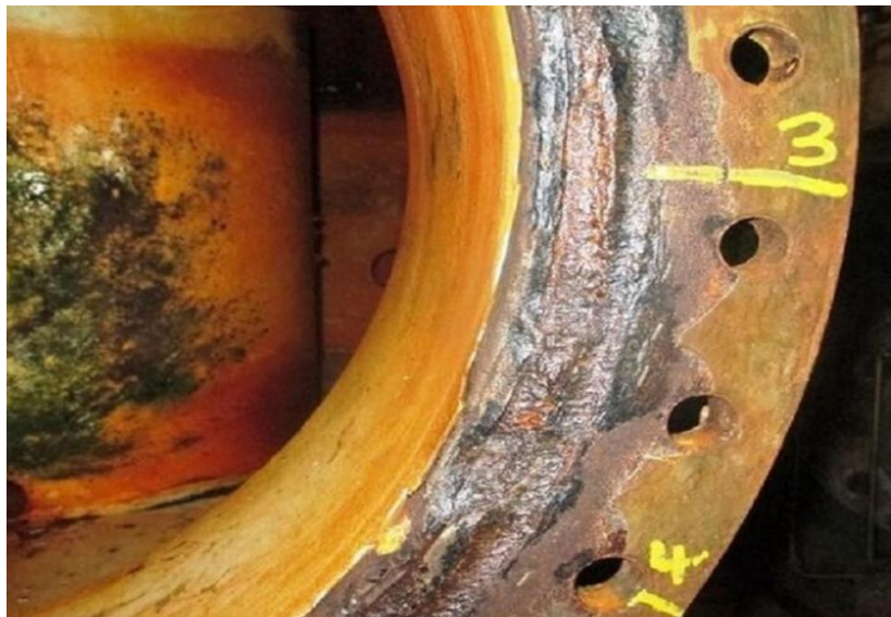
Slika 20. Oštećenje prirubnice od ugljičnog čelika nastalo nakon samo 3 mjeseca, a uzrokovano korozijom u procijepu spoja prirubnica [26]
