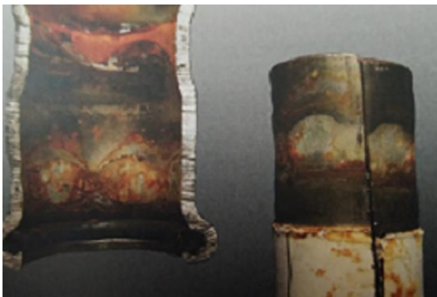
Slika 49. Korozija u procijepu nastala zbog djelovanja bakterija [1]
