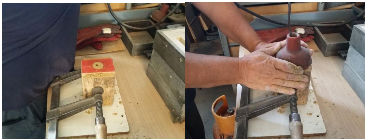
Slika 47. Propuhivanje jezgre plinom CO 2 radi očvrnuća
