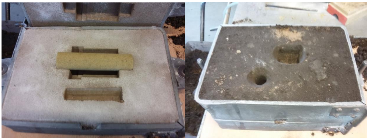
Slika 48. Umetanje jezgre u donjak i sklapanje kalupa
