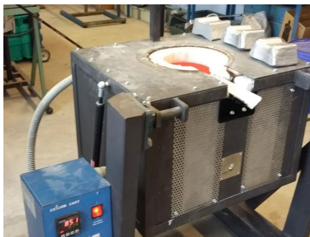
Slika 50. Peć zagrijana na 850 °C
