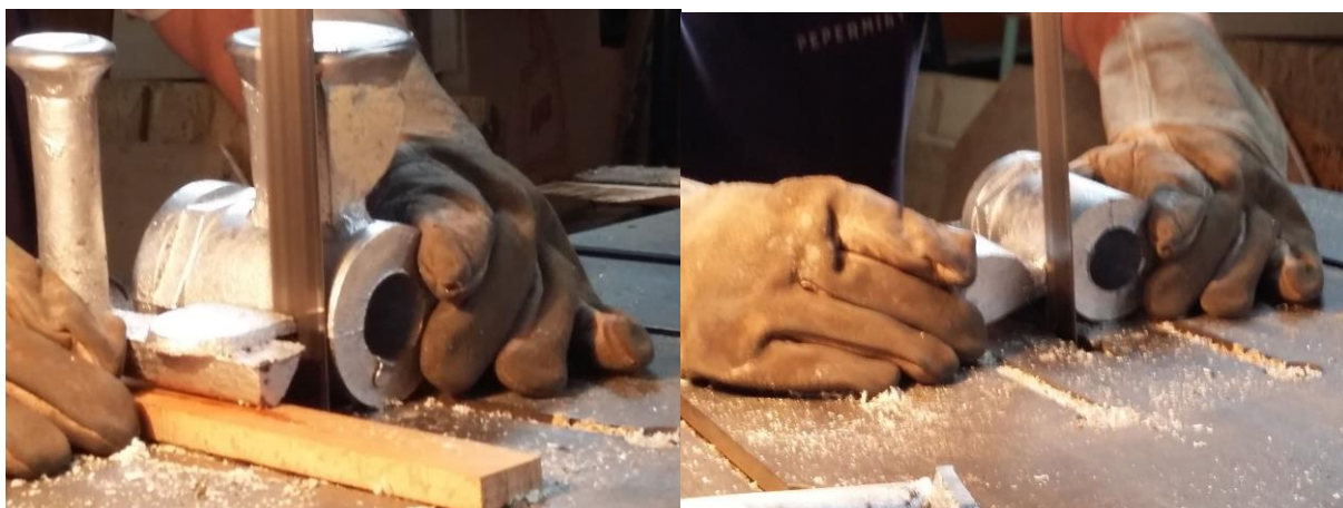
Slika 56. Razdvajanje odljevka od uljavnog sustava i sustava napajanja
