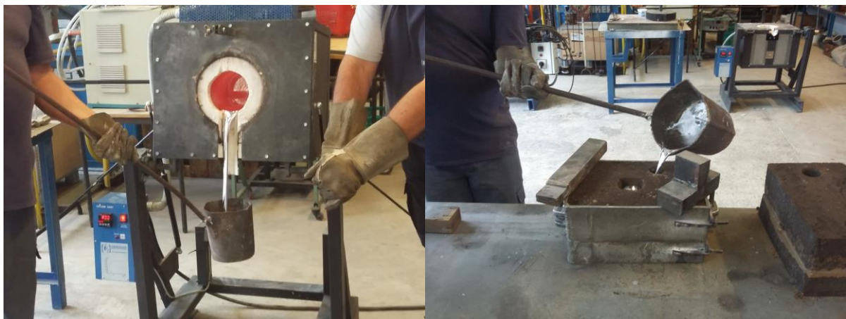
Slika 52. Lijevanje taline iz peći u lončić i uljevanje u kalup
