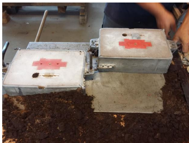
Slika 44. Gornjak i donjak prije vađenja modela, razvodnika i ušća
