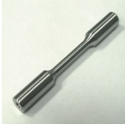
Slika 15. Epruveta za statičko vlačno ispitivanje [18]
