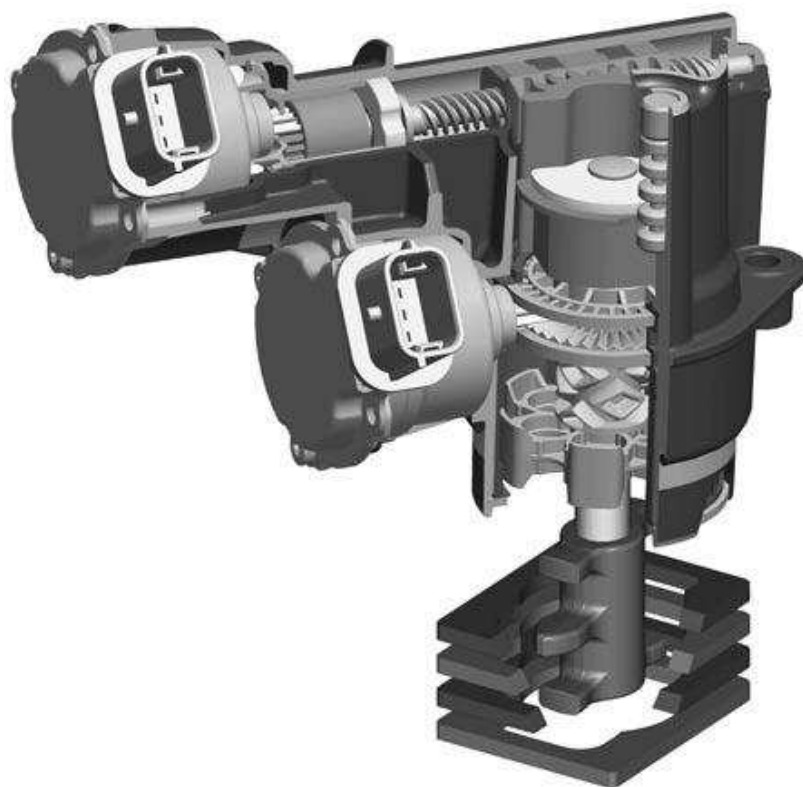
Slika 6.1: Aktuator izmjene stupnjeva prijenosa [4].
