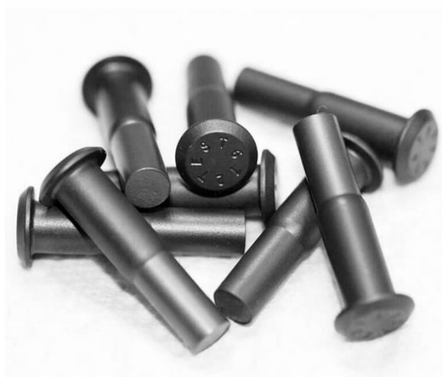
Slika 21. Titanij anodiziran tipom 2 [24]
