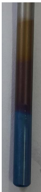
Slika 33. Uzorak anodiziran pri različitim naponima
