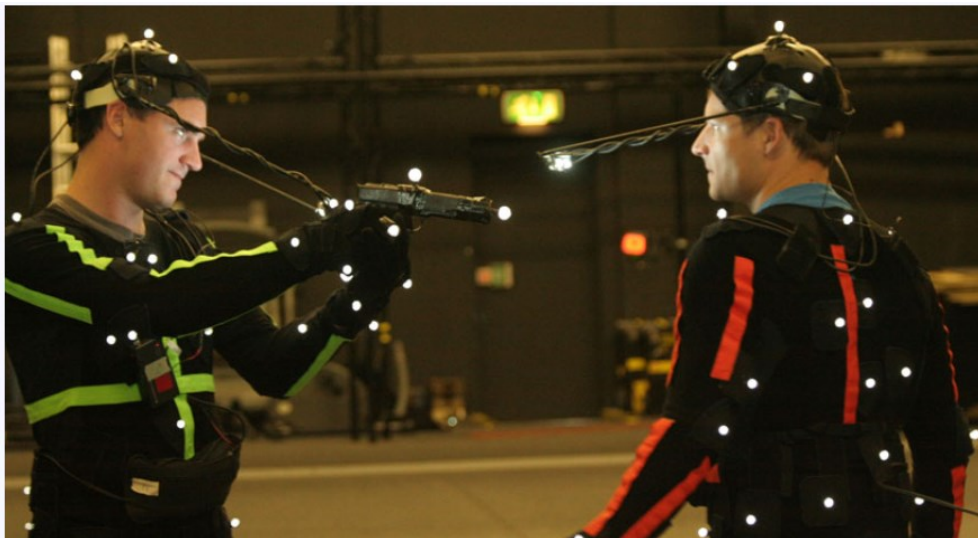
Slika 1. Snimanje pokreta odijelima sa LED [7]
