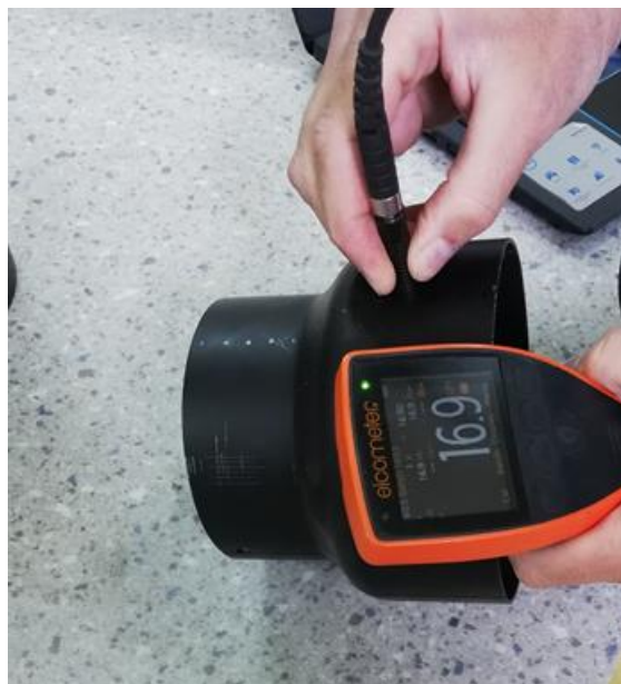
Slika 21. Prikaz tehnike mjerenja pomoću „Elcometer 456“
