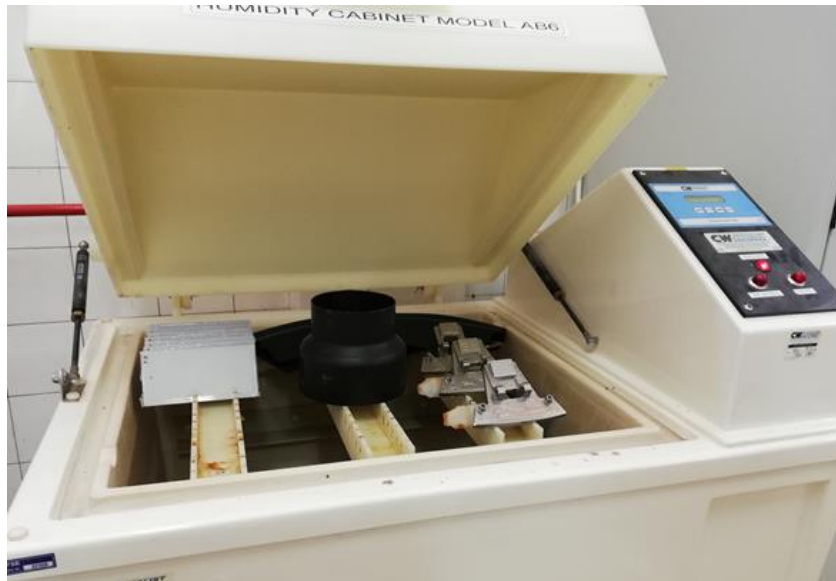
Slika 14. Uzorak broj 1 u vlažnoj komori, Laboratorij za zaštitu materijala
