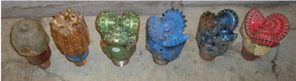
Slika 2.1 Bušne glave (dlijetla)
