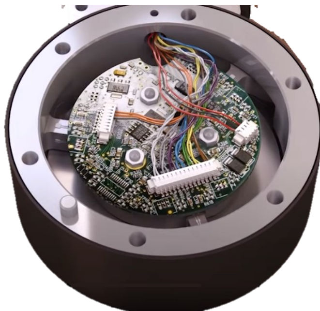
Slika 16. Elektronsko sklopovlje mjerne ćelije [15]
