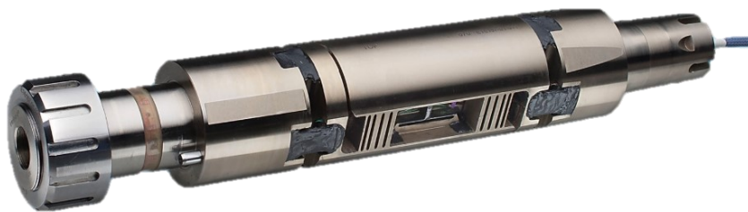
Slika 7. Monolitna unutarnja vaga opremljena tenzometarskim trakama [8]
