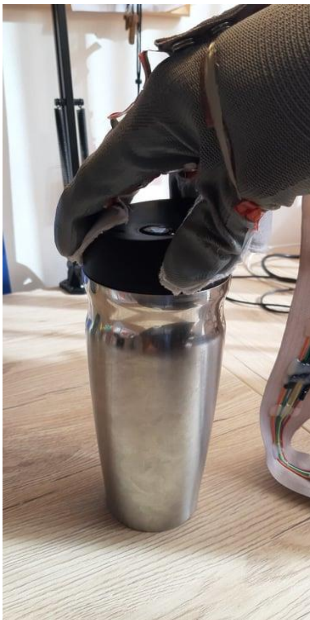
Slika 34. Hvatanje poklopca termos-boce prilikom njegovog uvrtnja i odvrtanja
