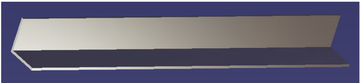
Slika 3.11 L-profil (HRN DIN 59413 20X20X1.5)
