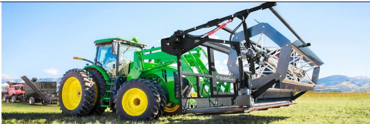
Slika 16. Cleancut berač za branje konoplje tvrtke Formation Ag
