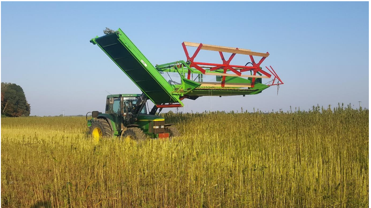
Slika 20. Berač za konoplju tvrtke Agroservis proizvodnja d.o.o.
