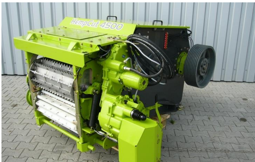
Slika 32. Agregat i jedinica za usitnjavanje stabljike
