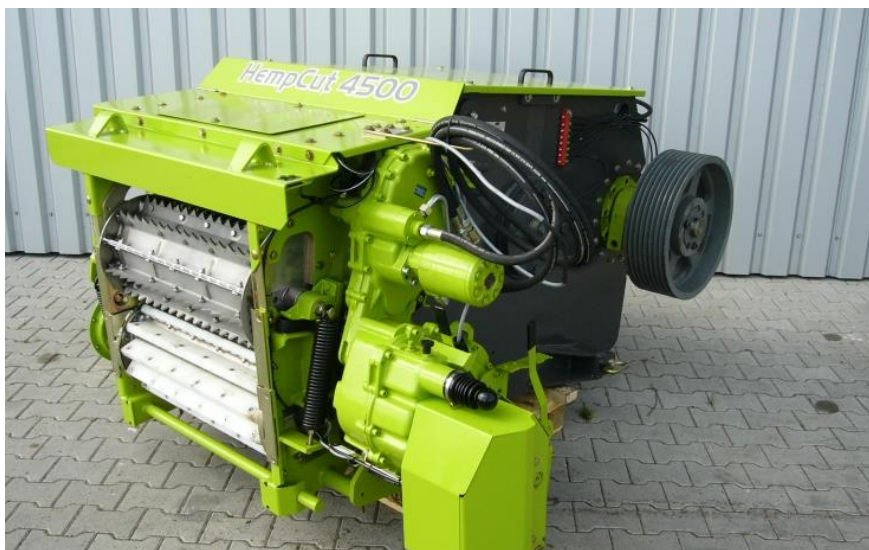
Slika 32. Agregat i jedinica za usitnjavanje stabljike
