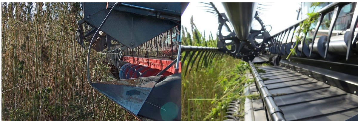
Slika 9. Uobičajeni uređaj za žetvu s pužnim transporterima (lijevo) i uređaj s trakastim transporterom
