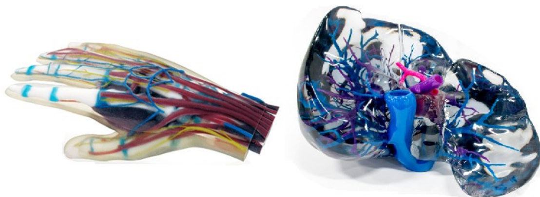
Slika 3. Modeli isprintani postupkom PolyJet [9][10]
