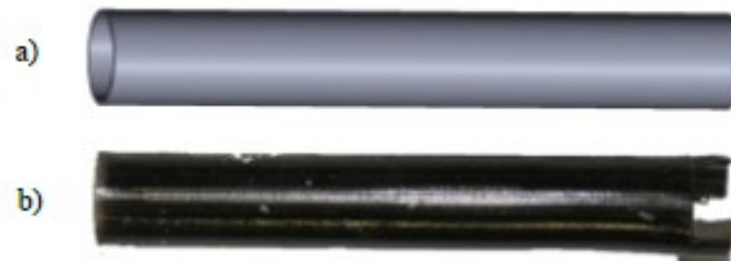
Slika 6. a) CAD model uzorak, b) ispisan model[16]
