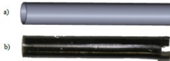
Slika 6. a) CAD model uzorak, b) ispisan model[16]
