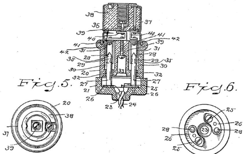
Slika 13. Prvi električni utikač i utičnica (U.S. Patent 774,250)
