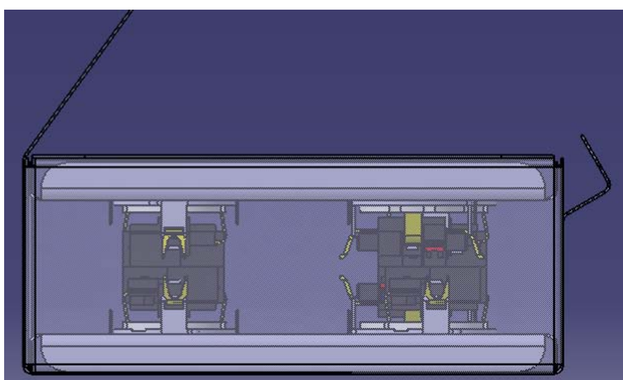
Slika 20. Smještaj zidnih priključnica unutar ambalaže (pogled s boka)
