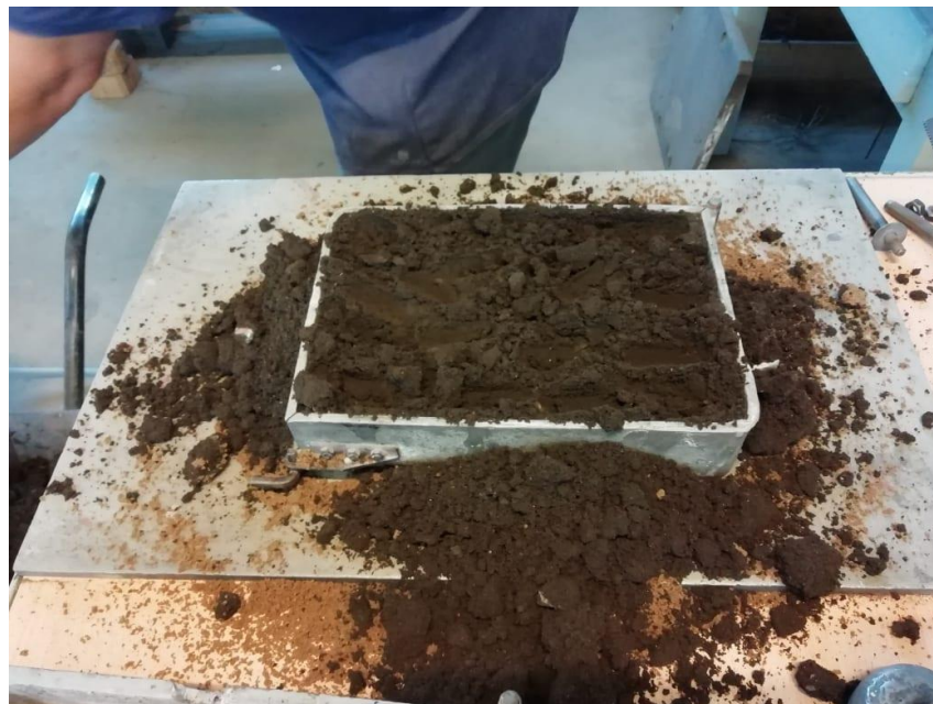
Slika 38. Stavljanje punidbene kalupne mješavine u donjak.
