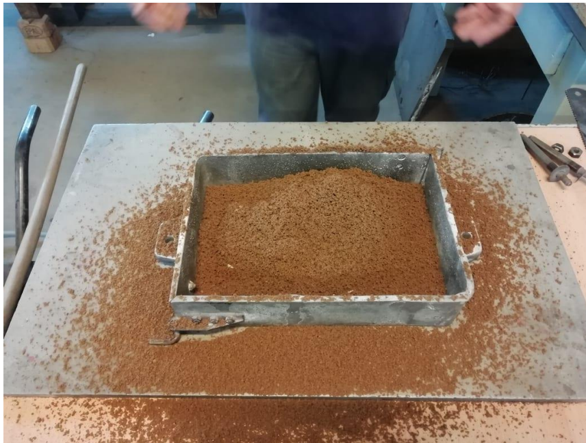
Slika 37. Stavljanje modelne kalupne mješavine u donjak.
