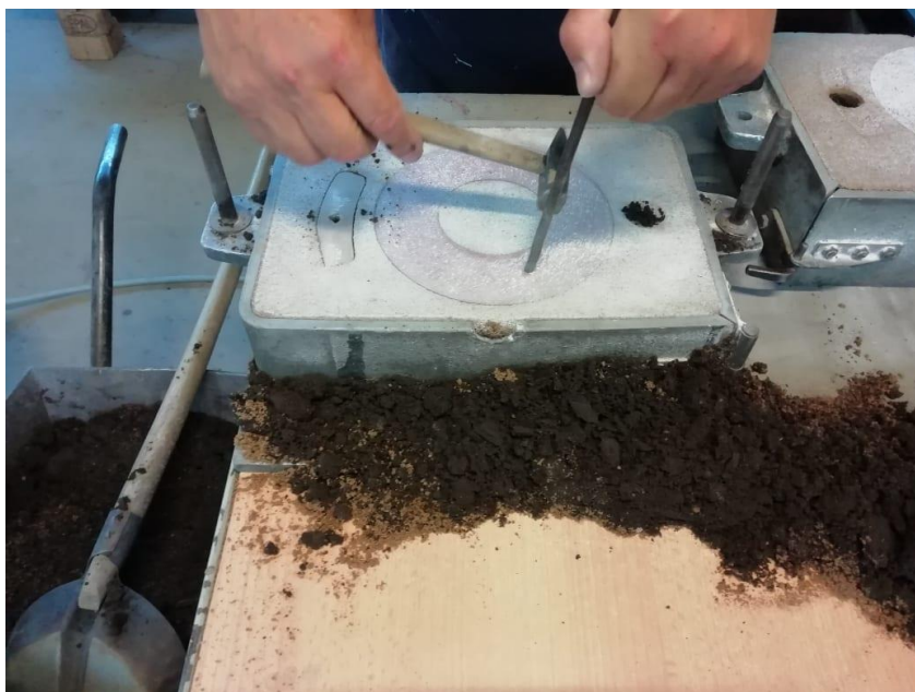
Slika 44. Vađenje modlea i razvodnika iz donjaka.
