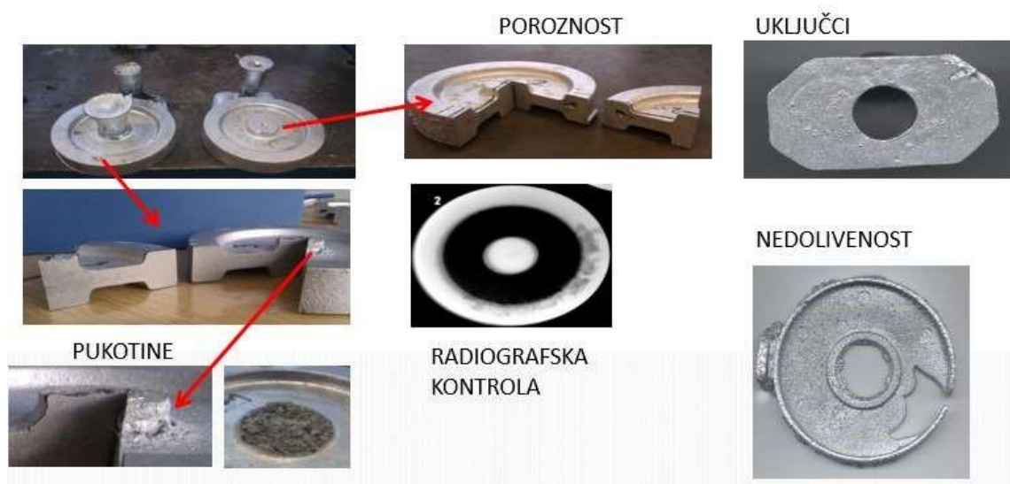
Slika 6. Temeljne pogreške na odljencima. [2]
