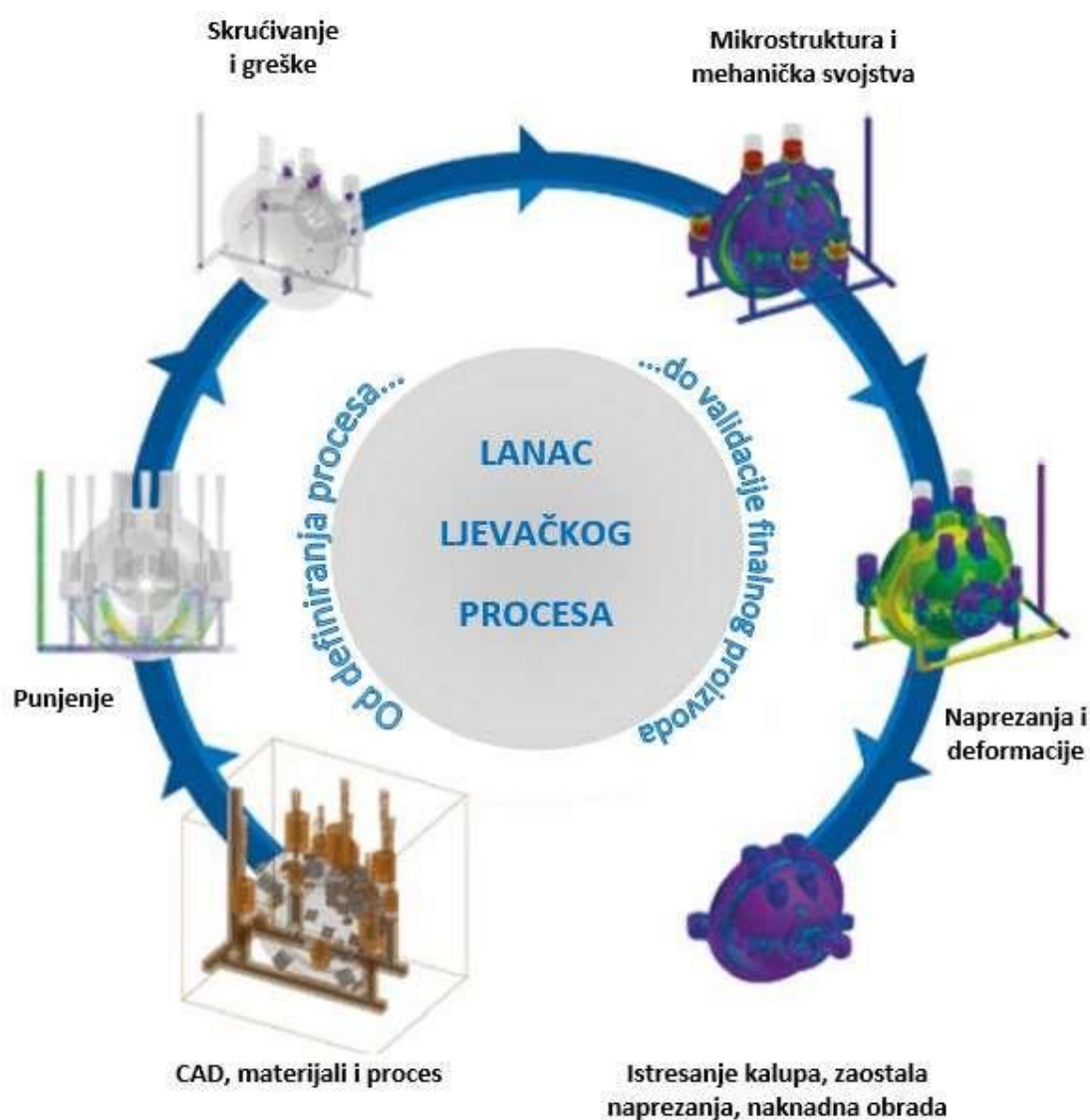
Slika 22. Simulacija ljevačkog procesa. [2]
