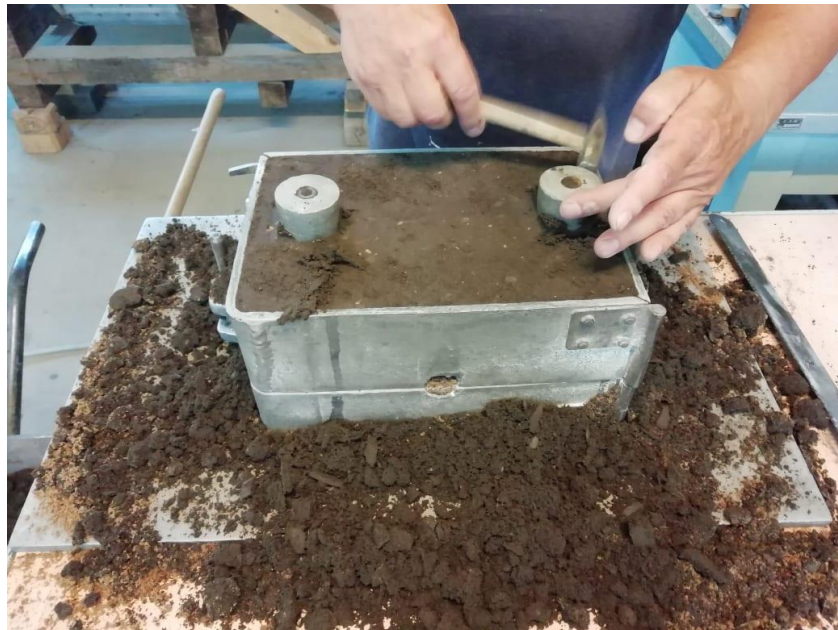
Slika 43. Postupak vađenja pojila i spusta iz gornjaka.
