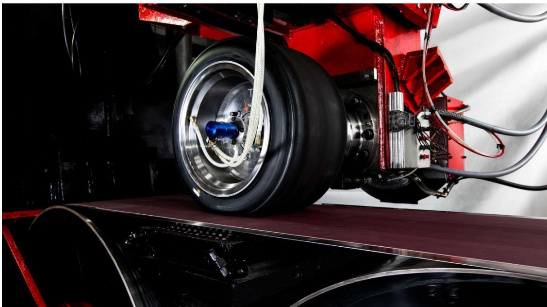
Slika 96. Ispitivanje pneumatika na Calspan ispitnom postavu, [2]
