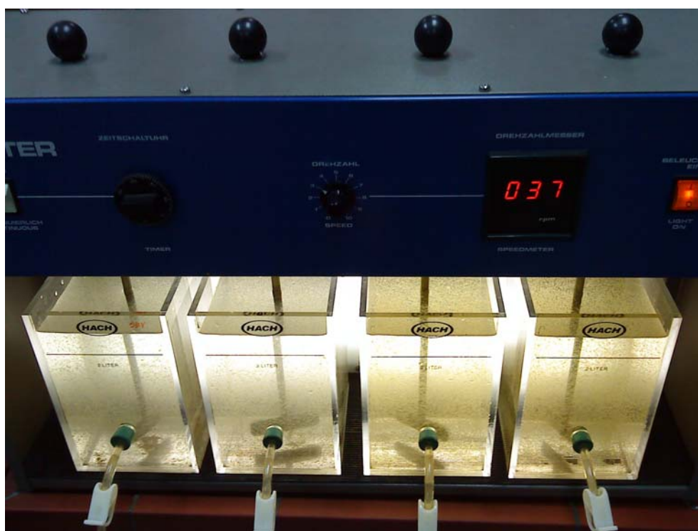
Slika 4. Flokulacija 100 i 200 \mu\text{L} \text{FeCl}_3
