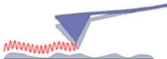
Slika 26. Shematski prikaz beskontaktna metode AFM [37]
