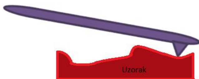
Slika 25. Shematski prikaz kontaktne metode AFM [33]
