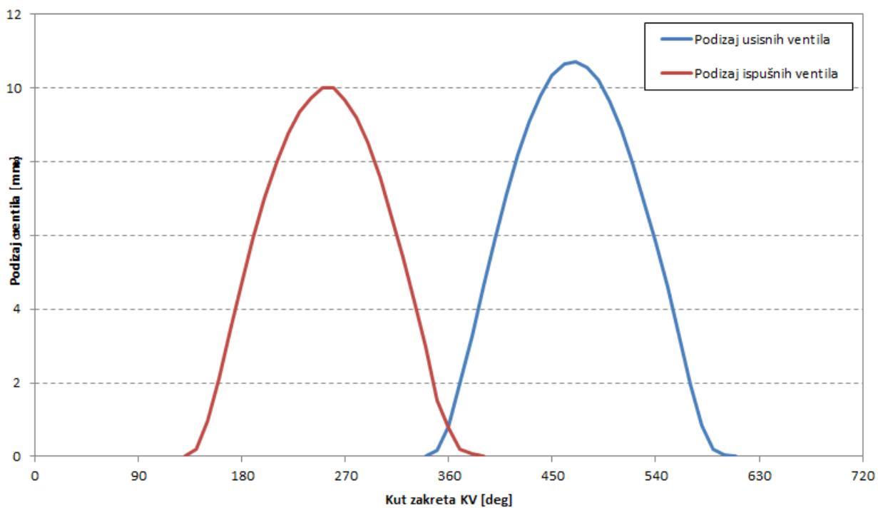
Slika 3.4. Dijagram podizaja usisnog i ispušnog ventila
