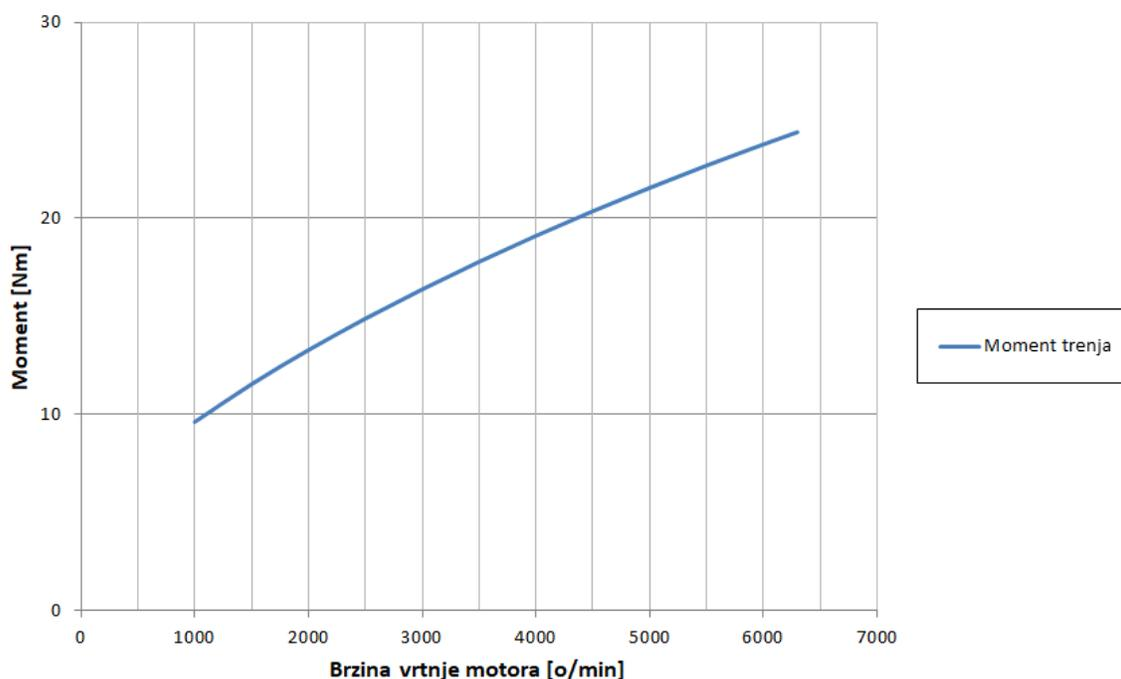
Slika 4.1. Moment mehaničkih gubitaka simuliranog motora
