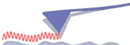
Slika 14. Beskontaktni način – princip rada [25]
