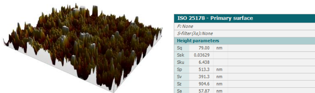
Slika 26. Uzorak 1 – 3D prikazi i 3D parametri topografije
