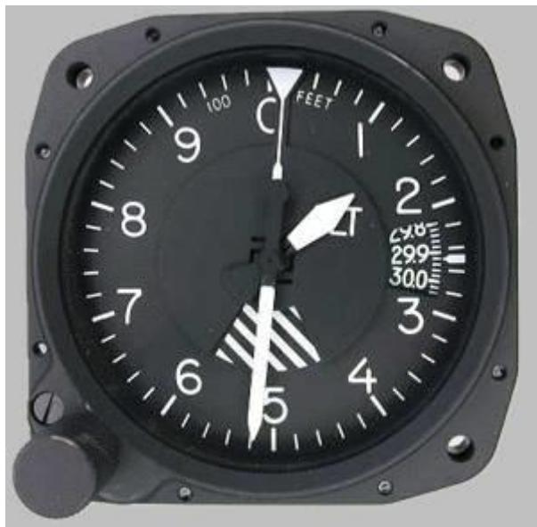
Slika 2.1. Barometarski visinomjer sa podjelom u stopama (feet)
