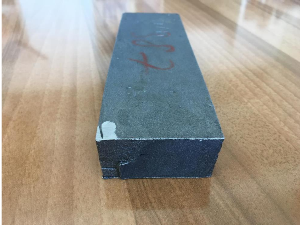
Slika 18. Odljevak lijeva oznake GX5CrNi 19-10
