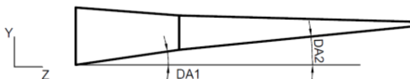
Slika 6. Parametri modela krila – bokocrt [6]
