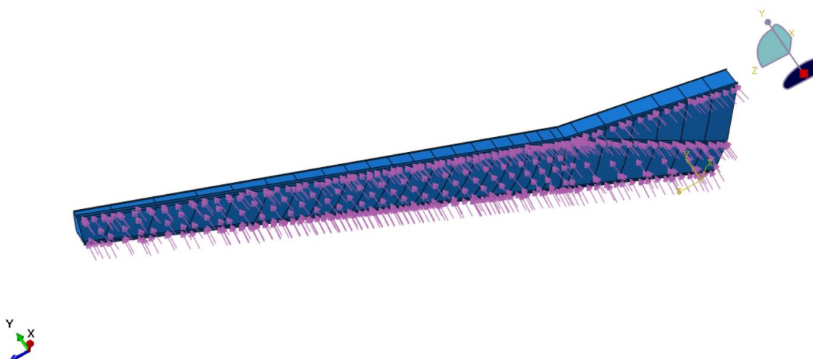
Slika 15. Tlačno opterećenje sile uzgona
