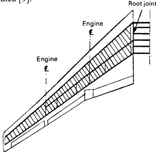
Slika 4.5: Krilo realne konstrukcije zrakoplova B747 [10]
