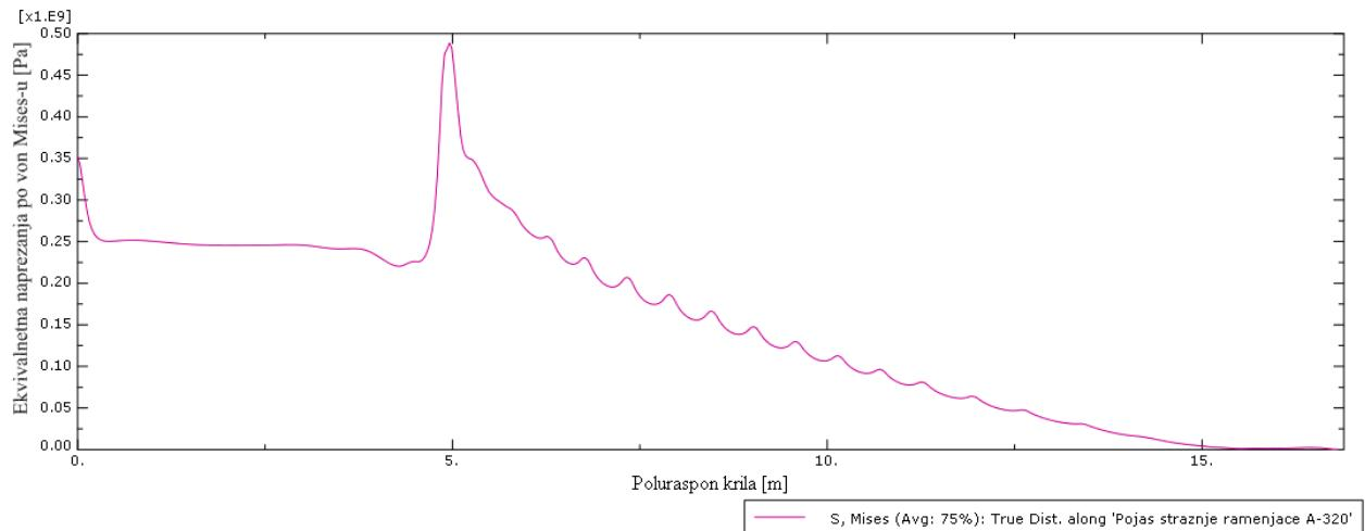
Slika 4.3: Von Mises naprezanja po pojusu stražnje ramenjače zrakoplova A-320
