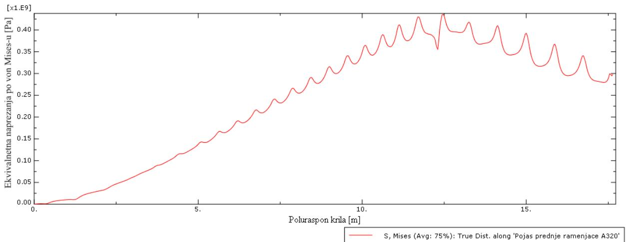
Slika 4.2: Von Mises naprezanja u pojusu prednje ramenjače zrakoplova A-320
