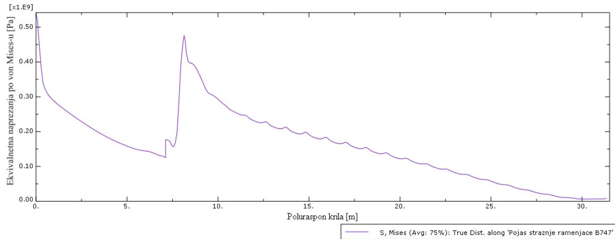
Slika 4.8: Von Mises naprezanja po pojusu stražnje ramenjače zrakoplova B747
