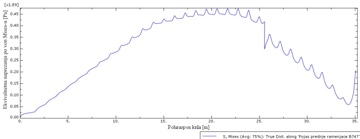
Slika 4.7: Von Mises naprezanja po pojusu prednje ramenjače zrakoplova B747
