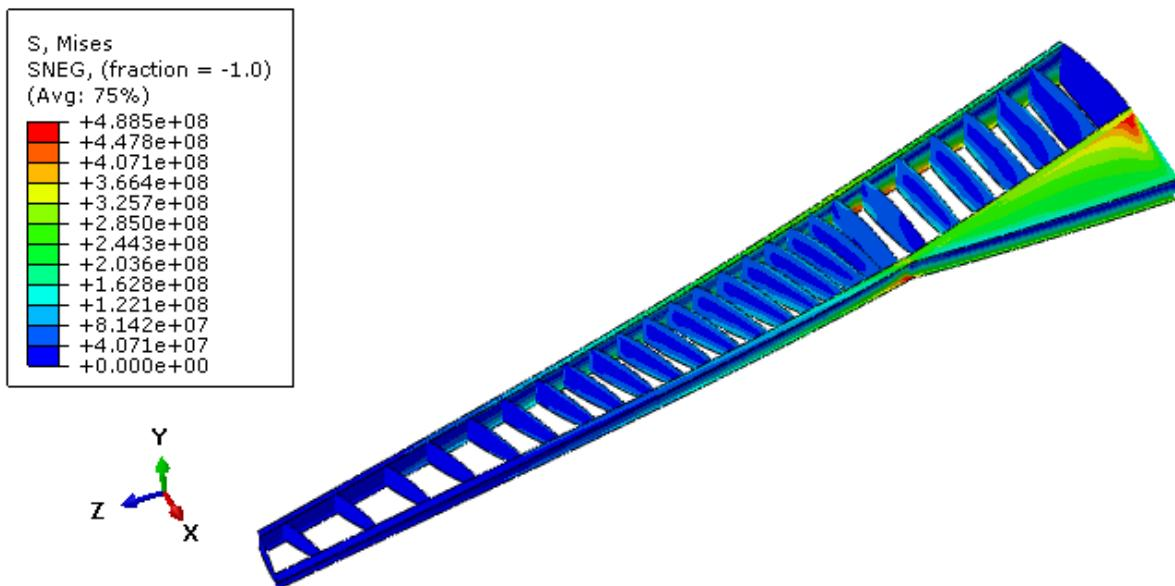
Slika 4.1: Naprezanja [Pa] prema von Mises-u za krilo A-320
