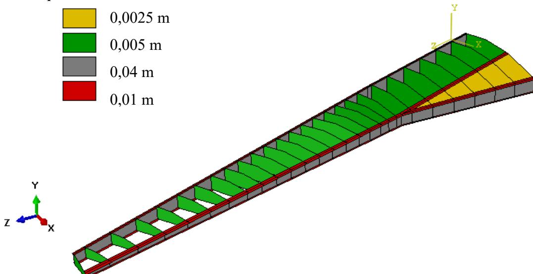
Slika 3.4: Debljine konstrukcijskih elemenata zrakoplova A-320
