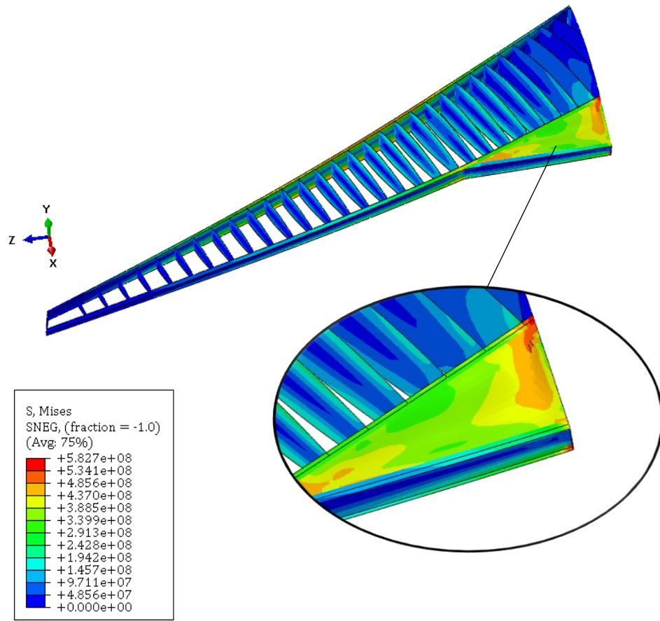
Slika 4.6: Naprezanja prema Von Misesu [Pa] za B747
