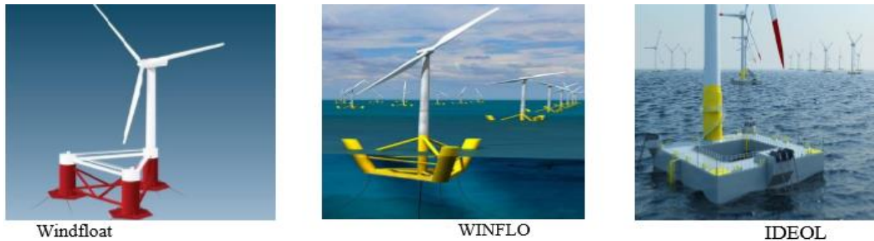
Slika 15. Primjeri plutajućih temelja [3]
