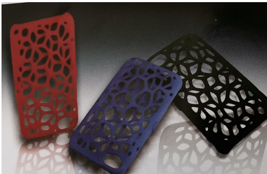
Slika 12. Maskica za iPhone dobivena postupkom izravne proizvodnje [10]
